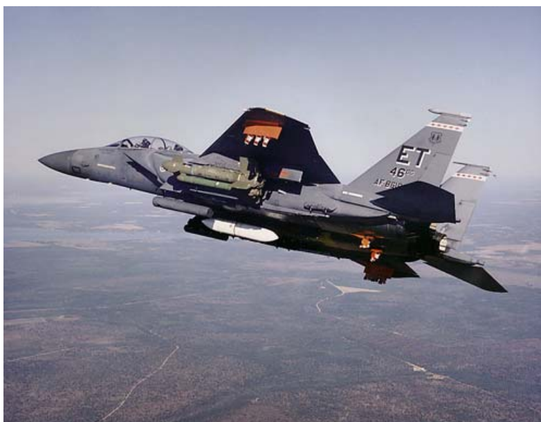
5. ábra. Lézerirányítású bombákkal felszerelt harcászati repülőgép
