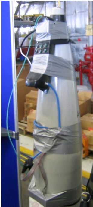
2. ábra. Vezeték nélküli telefonnal szerelt tüzérségi lőszer, mint RCIED [1]
