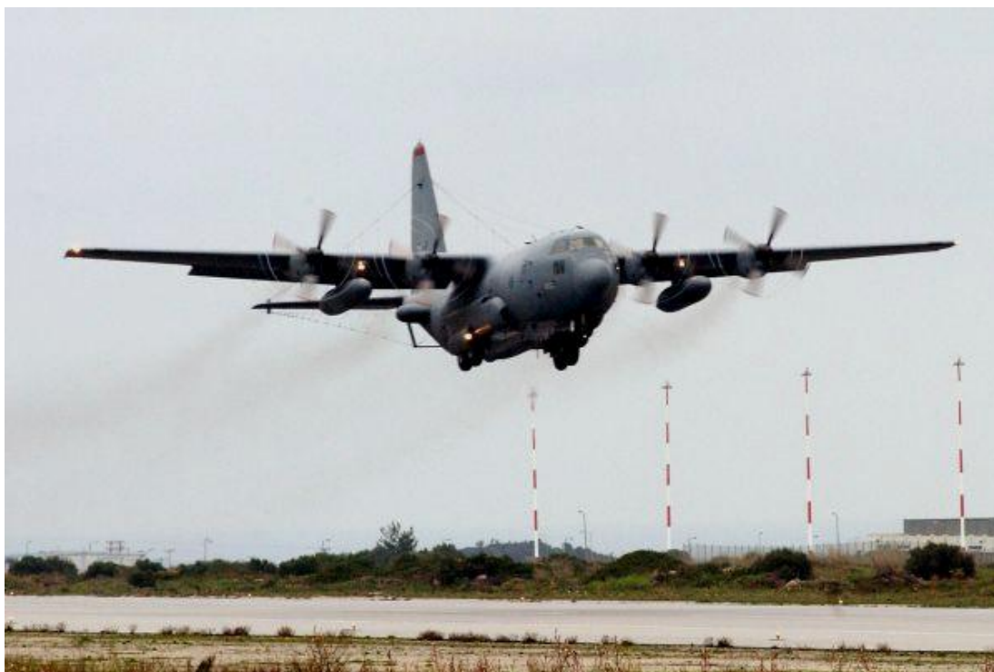
5. ábra. A Compass Call felszállás közben. (A képen jól megfigyelhető a gép hátsó részén a függőleges vezérsík alatt és fölött lévő antenna rendszer). [6]
