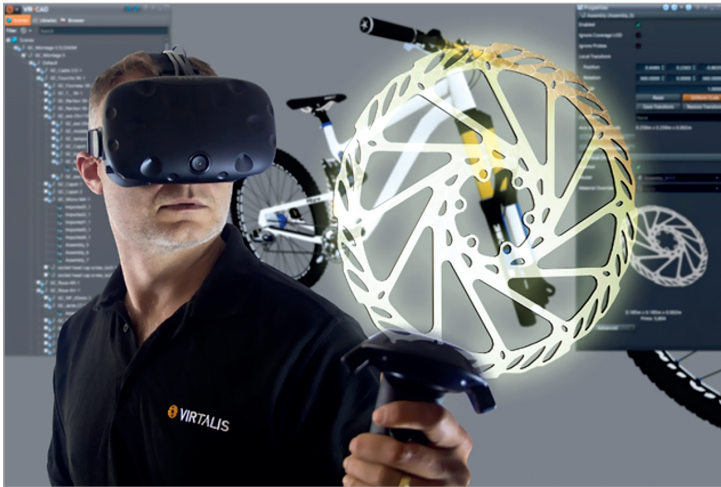
9. ábra: VR-megjelenítést támogató CAD-alkalmazás
