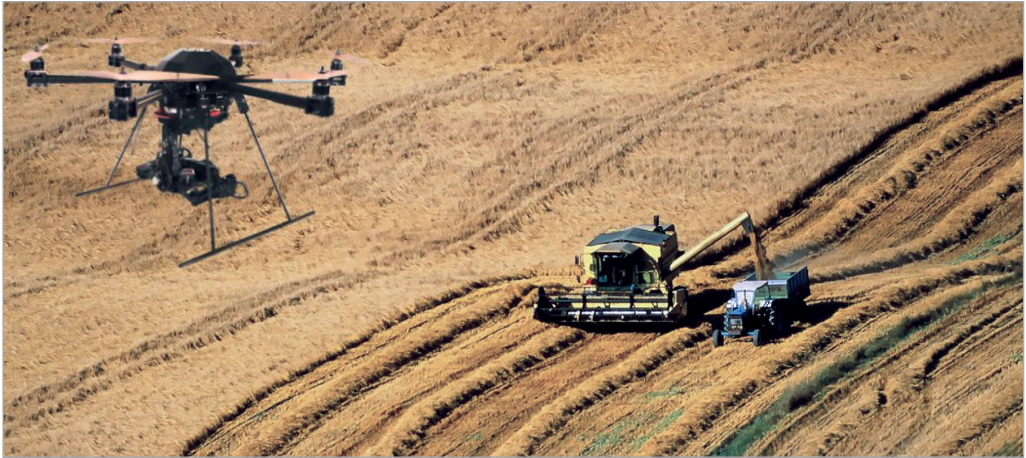
3. ábra: Mezőgazdasági precíziós dróntechnika megfigyeléshez, járműkövetéshez, permetezéshez, magonkénti vetéshez, állapotfelméréshez
