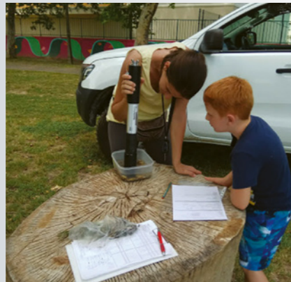
A bevonat klorofill koncentrációjának mérése Benthos Torch készülékkel
