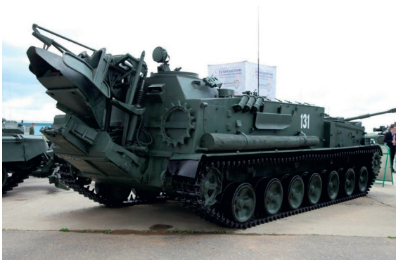
17. ábra: GMZ–3 típusú önjáró aknarakó
