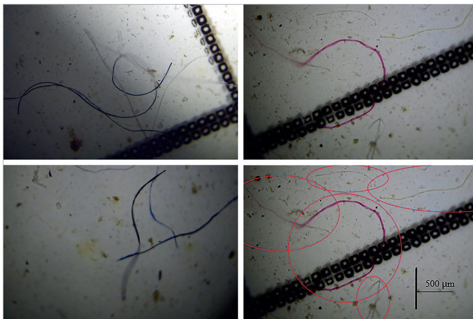
20. ábra: VTK VOB 100 m 3 -es esővíztározó-minta mikroműanyag szálainak mikroszkópos képei (a szerző felvételei)
