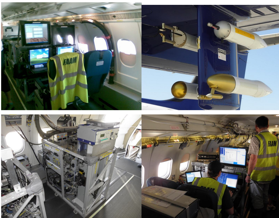
3. ábra. A. (bal felső kép): a mikrofizikai munkaállomás a BAe-146 fedélzetén B. (jobb felső kép): a mikrofizikai berendezéseket tartalmazó függesztett konténer; C. (bal alsó kép): a nefelométer berendezést tartalmazó konténer a fedélzetén; D. (jobb alsó kép): a repülés koordinátorának munkahelye (a szerző felvételei).
