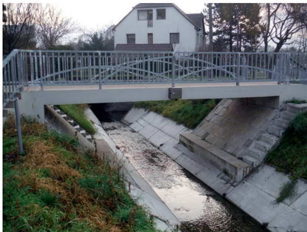
3. ábra: A Határ-árkon kihelyezett vízszintészlelő berendezés hídra szerelt mérődoboz (FCSM Árvízvédelmi Osztály felvétele)
