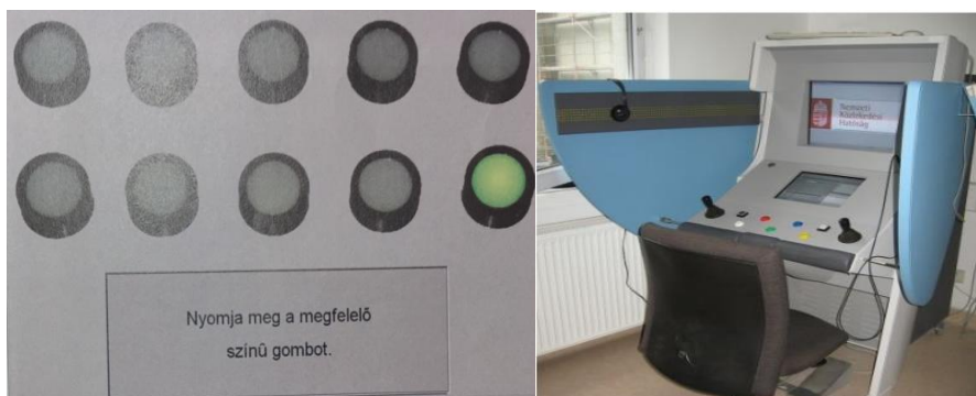
19. ábra Reaktív megterhelhetőséget vizsgáló eszköz (RST3; Forrás: Wenninger, & Krupan, 2003)
