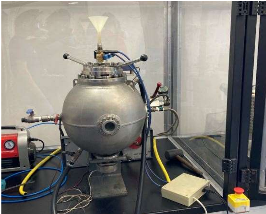
25. ábra: DCM vizsgálata egy vaslapra szerelt robbantókamrában. Készítette: A szerző.
