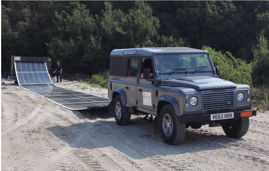
43. ábra: A solárszőnyeg gépi telepítése (saját felvétel a CL15 gyakorlatról)
