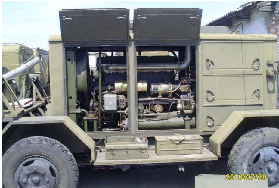
17. ábra: Szovjet gyártmányú ESD 50 kW-os dízelaggregátor vontatmány [80]
