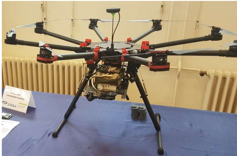
27. ábra: Magyar fejlesztésű MIMO technológiás adatrádió oktokofterre 83 szerelve, mint harctéri átjátszó, egy 2018-as bemutatón (saját felvétel)
