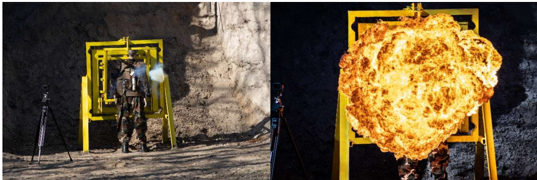
34. ábra: Tároló palackok 2023-as próbálövészete az MH Lőkísérleti Vizsgálóállomásán, Táborfalván (Zrínyi Média felvétele)
