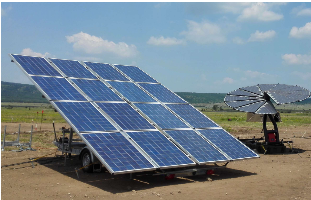
41. ábra: A kép előterében egy utánfutós mozgatható fix állásban telepíthető napelem, a háttérben egy automatikus napkövető egység (saját felvétel a CL15 gyakorlatról)
