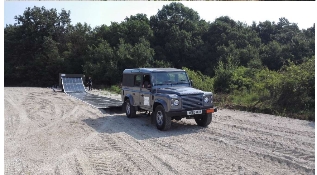
59. ábra: A brit Renowagen szolár-utánfutójának telepítése (saját felvételek a CL15 gyakorlatról)
