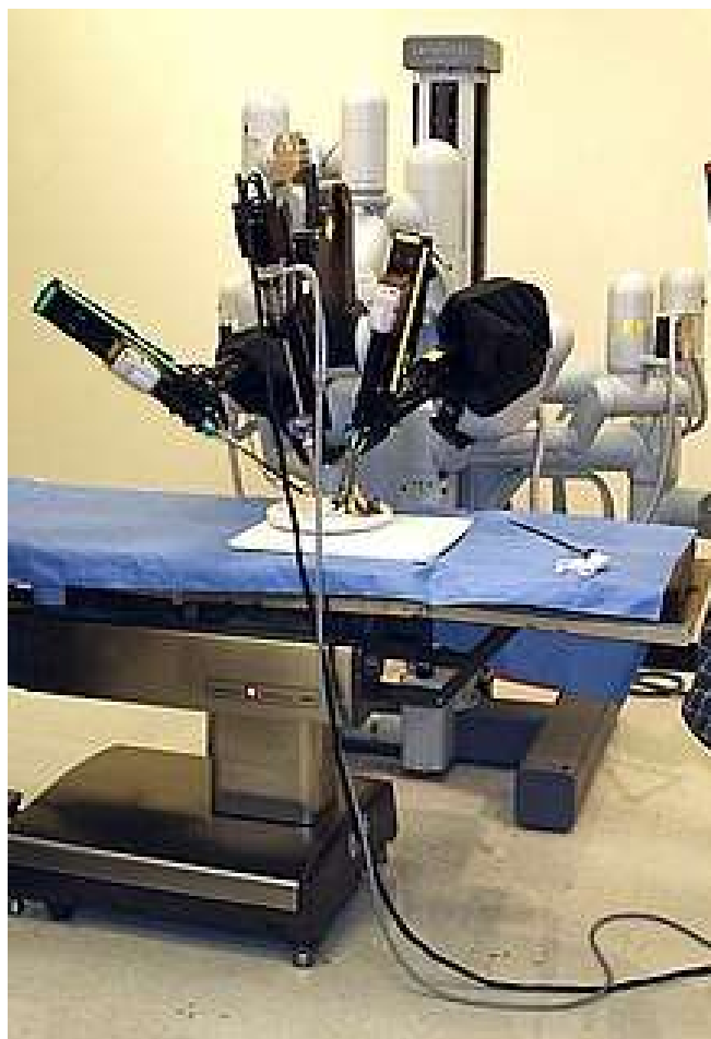
1. kép A „ da Vinci sebészeti rendszer ” operáló asztala a robottal [49]
