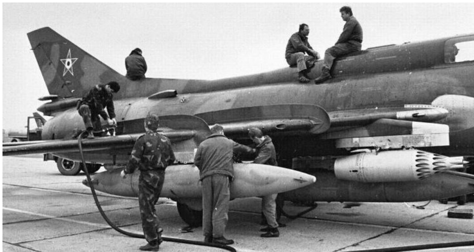
38.) sz. kép: A műszaki állomány a töltőzónában készíti elő – tölti fel üzemanyaggal – a repülőgépet ismételt felszállásra. A NIR UB-blokkot kinn az indítózónában töltik majd fel SZ-5K rakétákkal 958
