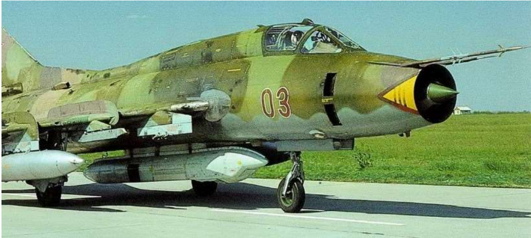
39.) sz. kép: a 03-as oldalszámú repülőgép vizuális és rádiótechnikai felderítési feladatra történő felszálláshoz gurul ki a felszálló mezőbe a század RHGY idején. Felderítő konténerrel – KKR-1TE – a törzse alá függesztve, s a szárnyak alatt póttartályokkal 959
