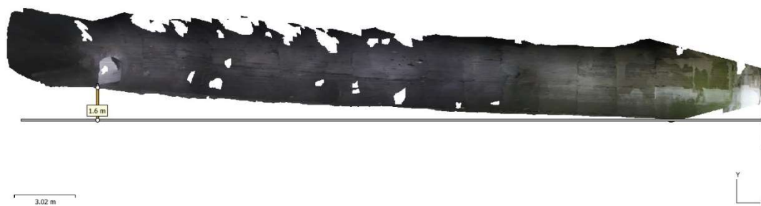
Az alagút emelkedésének számítása a 3D modell alapján
