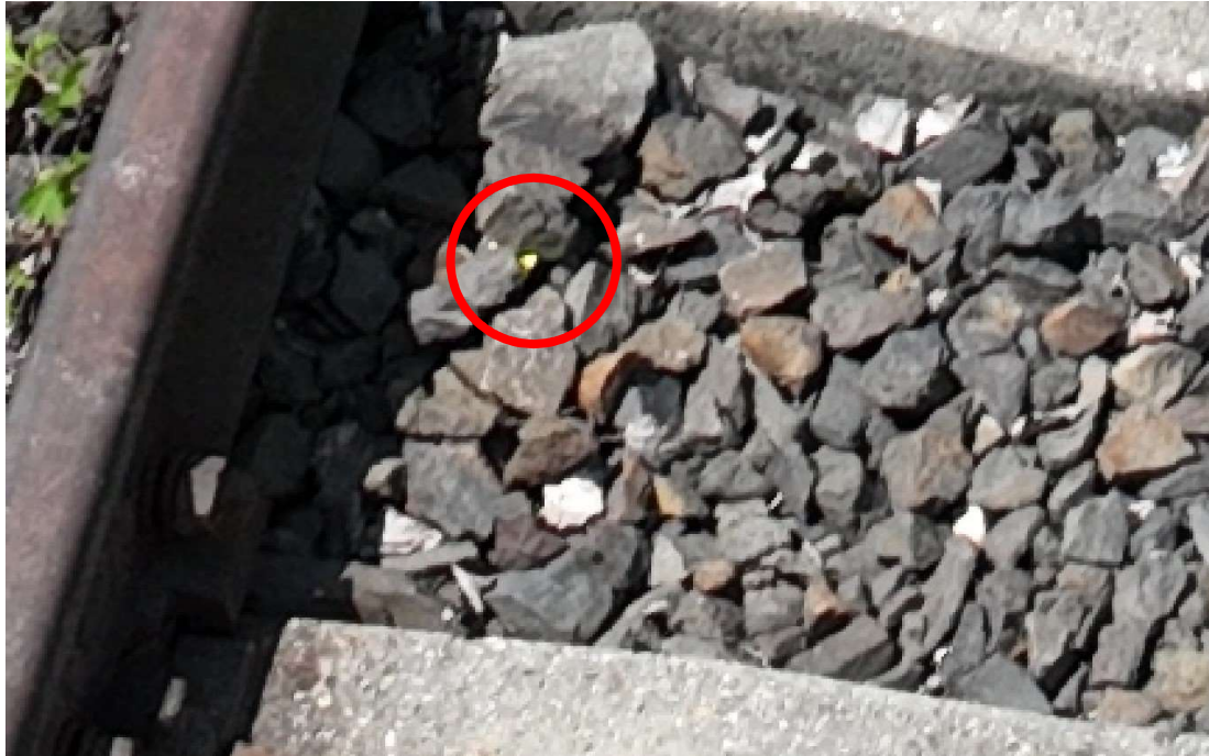
Az ágyzatba rejtett sárga doboz felismerhetősége drónfelvételen (csak 15 m repülési magasságból készített felvételen és megfelelő nagyítás mellett látható)
