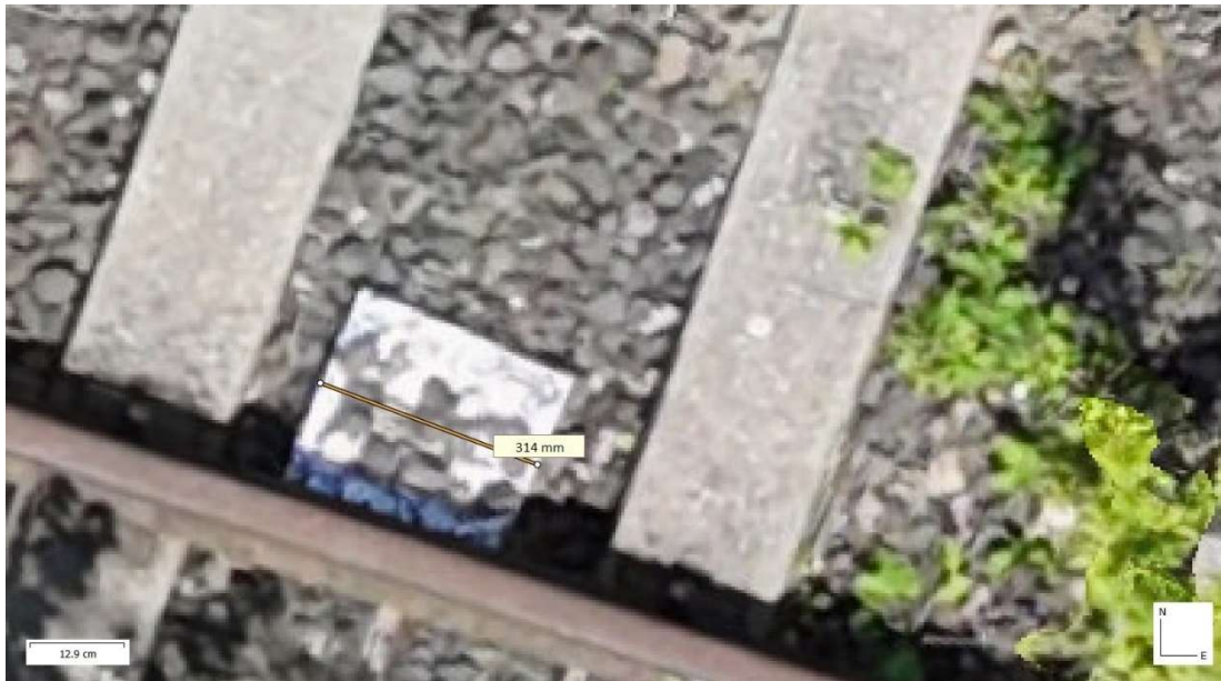
A sínszál mellé helyezett doboz felismerhetősége és mérete (a vasóságban 307 mm)
