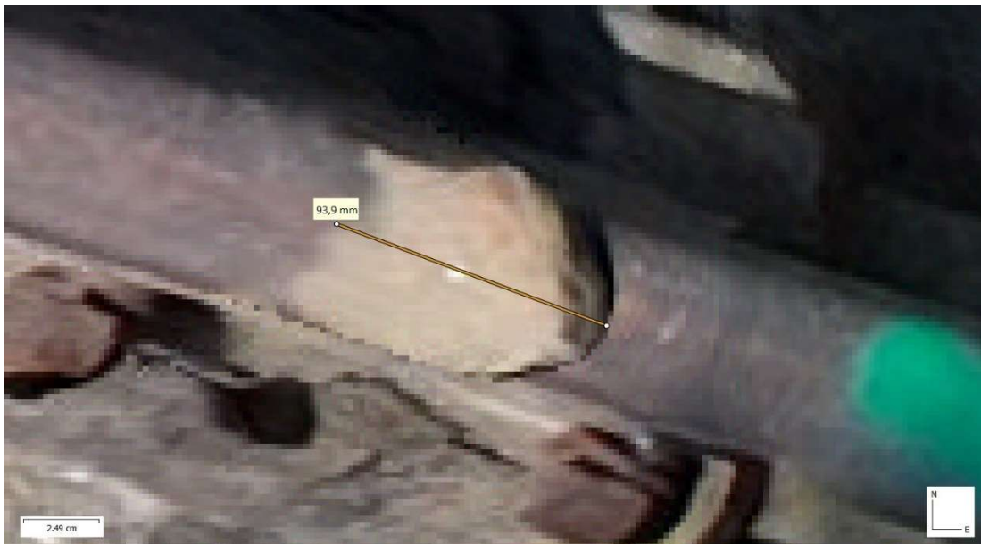
A sínre helyezett kő méretének megállapítása a modell alapján (a valóságban 93 mm)
