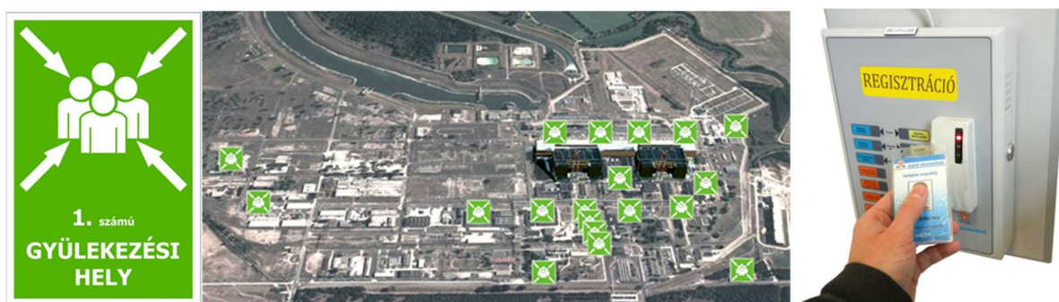
22. ábra. Gyülekezési helyre figyelmeztető tábla (bal oldal), gyülekezési pontok a telephelyen (középen), regisztrációt segítő blokkoló óra. Forrás: [saját]
