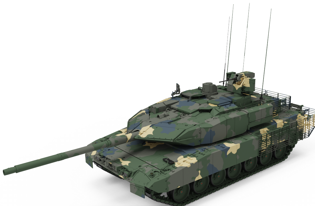
10. ábra. A LEOPARD 2A7HU harckocsi kumulatív töltetű lövedékek ellen optimalizált, minden irányból védelmet nyújtó kiegészítő 231 páncélzattal. (Nagy Norbert)
