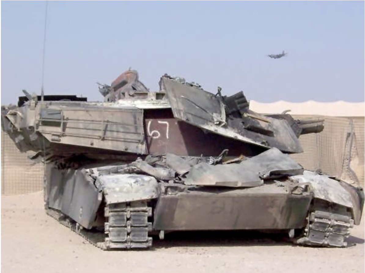
19. ábra. Megsemmisült M1 Abrams. Jól látható a felszakadt oldalsó kazamata tér a torony oldalán. ( http://www.ointres.se/projekt_stridsvagn_ny.htm , letöltve: 2022. február 12. 14:00)
