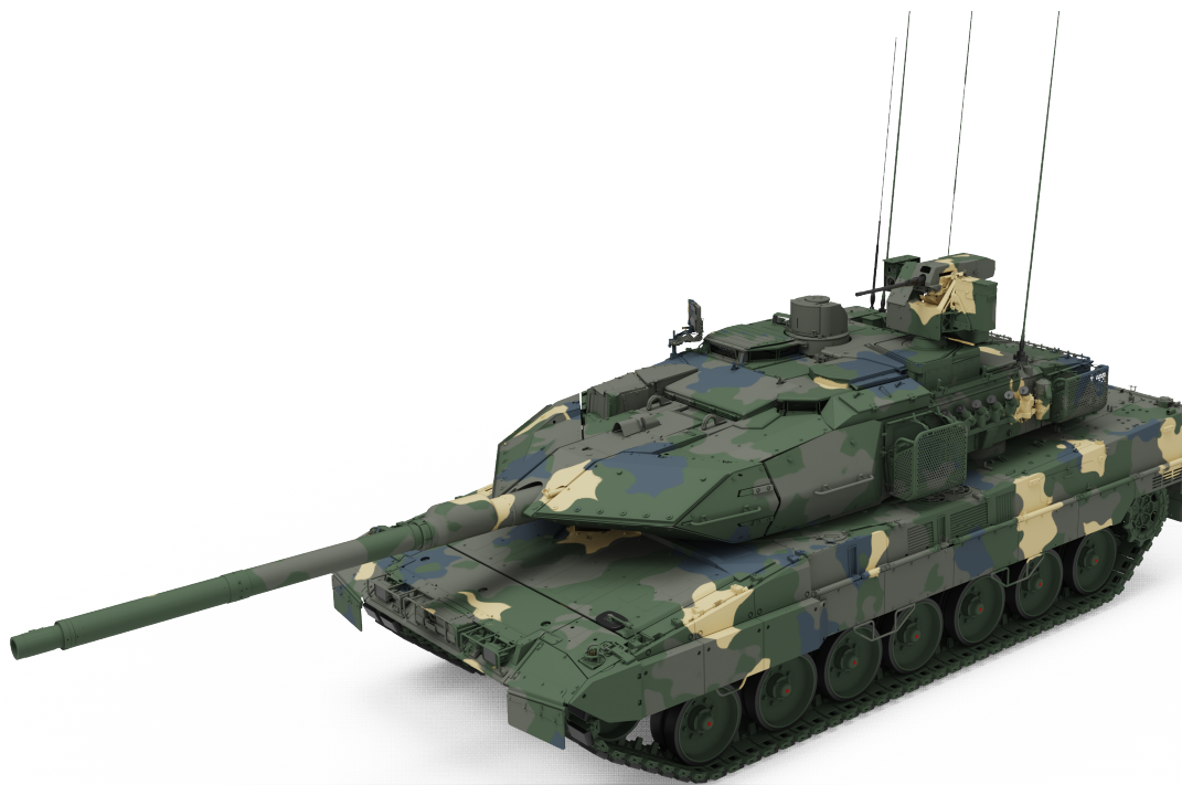
9. ábra. A LEOPARD 2A7HU harckocsi űrméret alatti fegyverek elleni védelemre optimalizált kiegészítő páncélzattal. A modul elemek a szemből érkező találatok elleni védelmet biztosítják. (Nagy Norbert)
