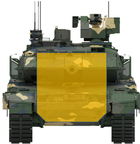
11. ábra. A Leopard 2A7HU harckocsi hatásos célfelülete szemből (felül) és oldalról (alul) sárgával jelölve. Azok a találatok, melyek ezen kívül esnek, az esetek többségében nem eredményezik a harckocsi harcképtelenné válását. (Szerkesztette: Nagy Norbert)
