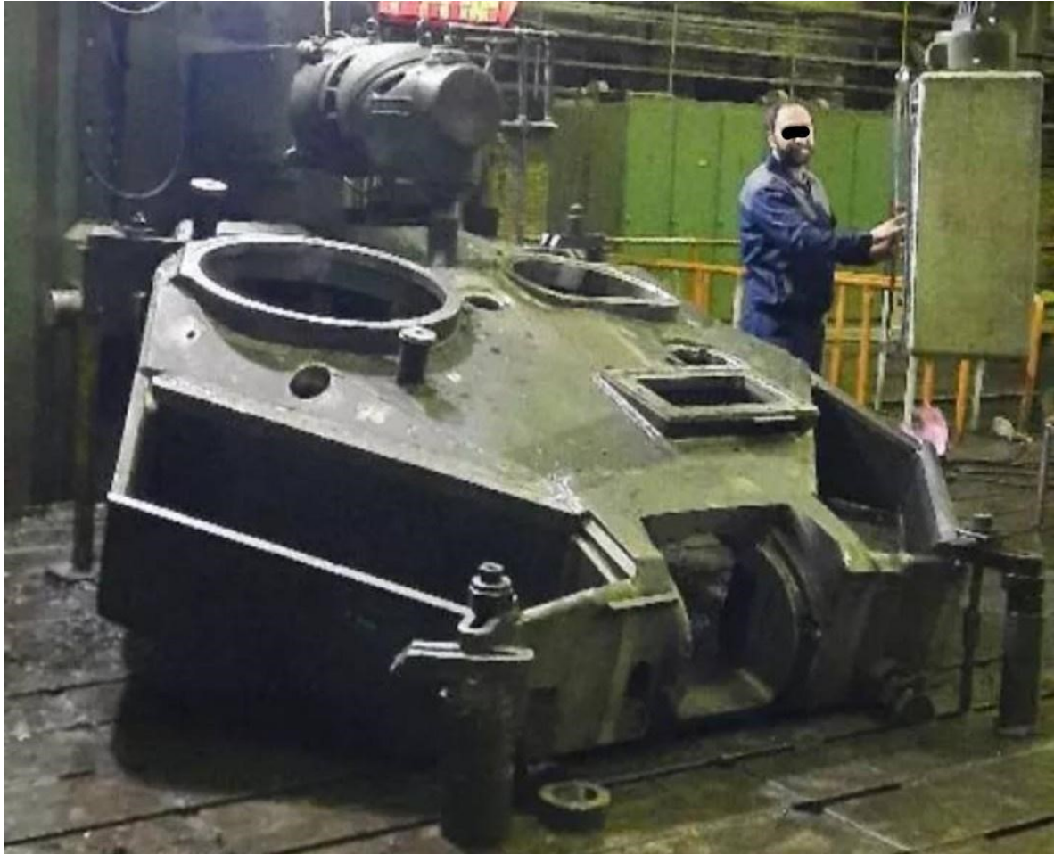
16. ábra. A T90A másolataként Iránban fejlesztett Karrar harckocsi kazamata szerkezetű tornya. Jól láthatók a mellső részen, még nyitott kazamataterek, melyekbe különleges összetételű páncélosztruktúrákat helyeznek, majd lehegesztik. A kazamata szerkezetű rész, a legveszélyeztetettebb, mellső front részen védi a küzdőteret. ( https://tanks-encyclopedia.com/karrar-main-battle-tank/ , letöltve: 2022. október 14-12.50.)
