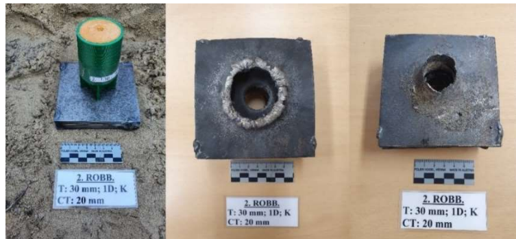
42. ábra: A 2. töltet a céltárgyon rögzítve, a céltárgy robbantás után megtalált legfelső és legalsó lemeze Forrás: a szerző szerkesztése.
