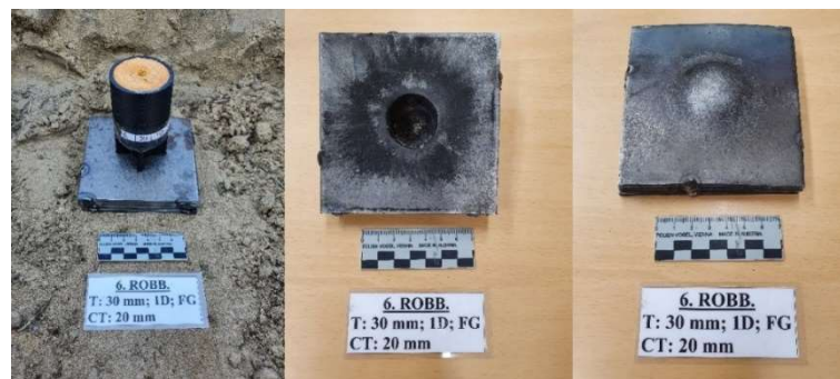
46. ábra: A 6. töltet a céltárgyon rögzítve, a céltárgy robbantás után megtalált legfelső és legalsó lemeze
