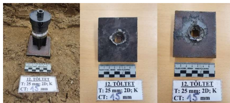
76. ábra: A 12. töltet a céltárgyon rögzítve, a robbantás után a céltárgy teteje és alja
