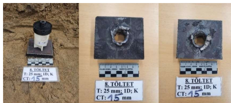
72. ábra: A 8. töltet a céltárgyon rögzítve, a robbantás után a céltárgy teteje és alja Forrás: a szerző szerkesztése.
