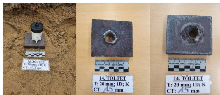
78. ábra: A 14. töltet a céltárgyon rögzítve, a robbantás után a céltárgy teteje és alja
