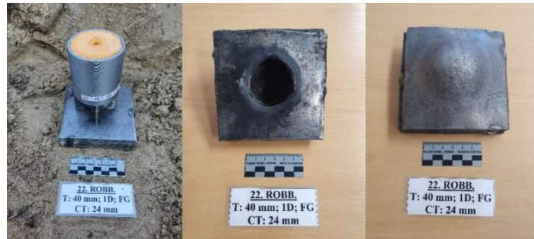
62. ábra: A 22. töltet a céltárgyon rögzítve, a céltárgy robbantás után megtalált legfelső és legalsó lemeze
