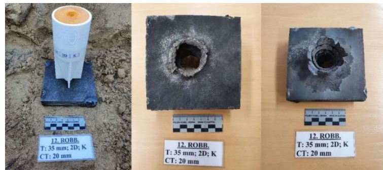
52. ábra: A 12. töltet a céltárgyon rögzítve, a céltárgy robbantás után megtalált legfelső és legalsó lemeze
