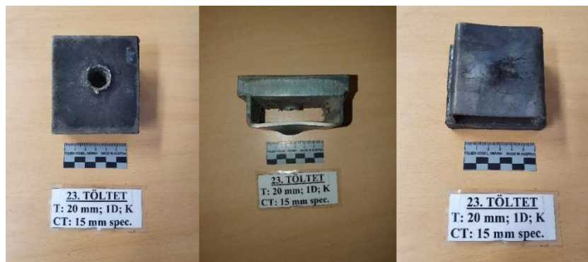
96. ábra: A 23. töltet céltárgya felülről, oldalról és alulról a robbantás után
