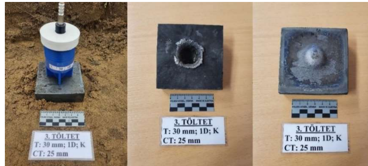
67. ábra: A 3. töltet a céltárgyon rögzítve, a robbantás után a céltárgy teteje és alja
