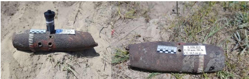
92. ábra: A 9. töltet a céltárgyon rögzítve és a kialakult lyuk a robbantás után
