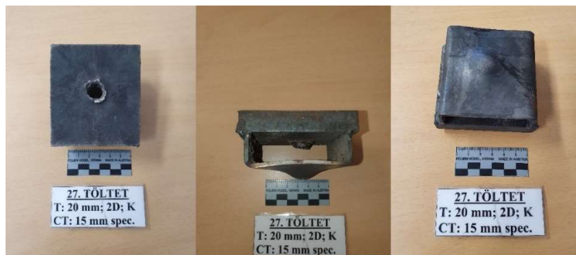
100. ábra: A 27. töltet céltárgya felülről, oldalról és alulról a robbantás után
