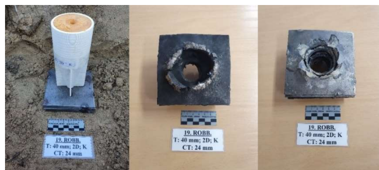
59. ábra: A 19. töltet a céltárgyon rögzítve, a céltárgy robbantás után megtalált legfelső és legalsó lemeze
