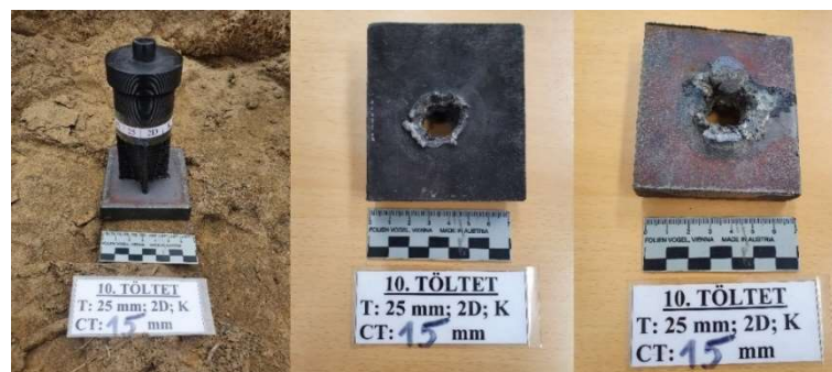
74. ábra: A 10. töltet a céltárgyon rögzítve, a robbantás után a céltárgy teteje és alja Forrás: a szerző szerkesztése.
