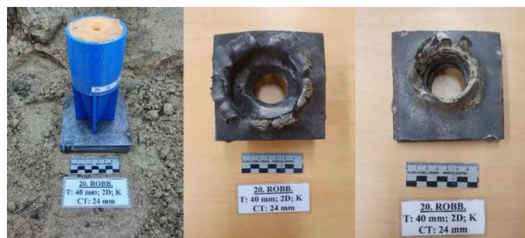
60. ábra: A 20. töltet a céltárgyon rögzítve, a céltárgy robbantás után megtalált legfelső és legalsó lemeze
