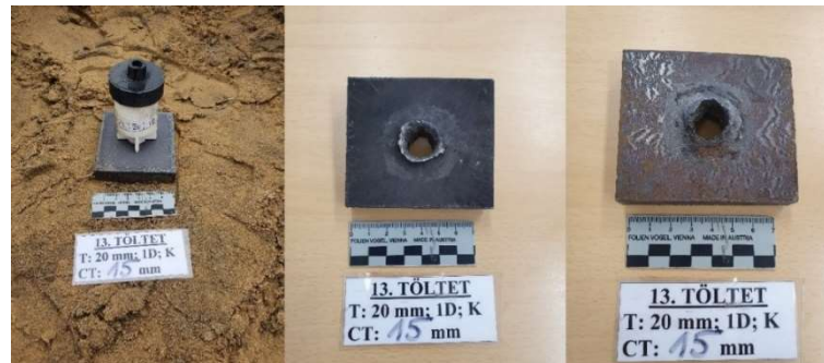
77. ábra: A 13. töltet a céltárgyon rögzítve, a robbantás után a céltárgy teteje és alja
