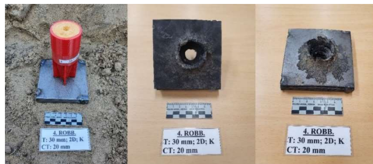
44. ábra: A 4. töltet a céltárgyon rögzítve, a céltárgy robbantás után megtalált legfelső és legalsó lemeze Forrás: a szerző szerkesztése.
