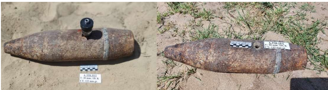
87. ábra: A 4. töltet a céltárgyon rögzítve és a kialakult lyuk a robbantás után
