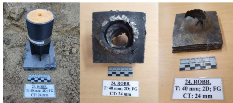
64. ábra: A 24. töltet a céltárgyon rögzítve, a céltárgy robbantás után megtalált legfelső és legalsó lemeze
