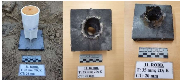
51. ábra: A 11. töltet a céltárgyon rögzítve, a céltárgy robbantás után megtalált legfelső és legalsó lemeze
