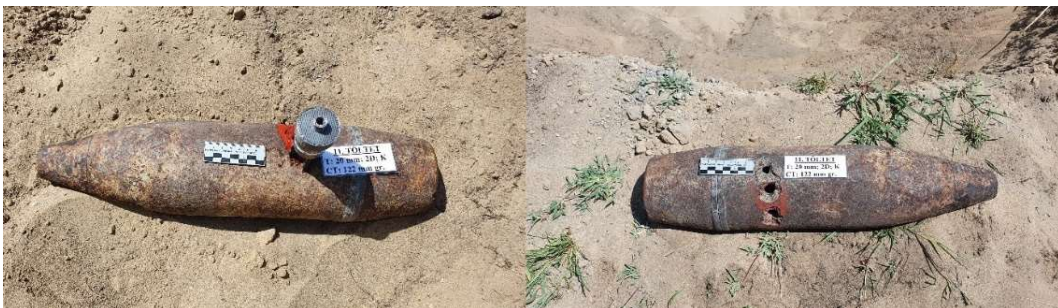
94. ábra: A 11. töltet a céltárgyon rögzítve és a kialakult lyuk a robbantás után
