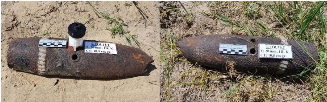
86. ábra: A 3. töltet a céltárgyon rögzítve és a kialakult lyuk a robbantás után
