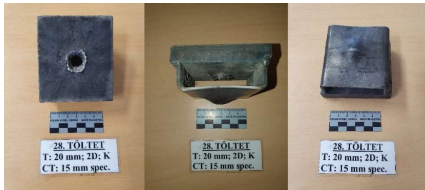
101. ábra: A 28. töltet céltárgya felülről, oldalról és alulról a robbantás után
