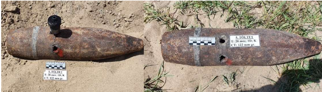
88. ábra: Az 5. töltet a céltárgyon rögzítve és a kialakult lyuk a robbantás után
