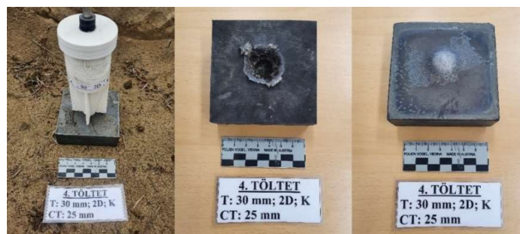
68. ábra: A 4. töltet a céltárgyon rögzítve, a robbantás után a céltárgy teteje és alja
