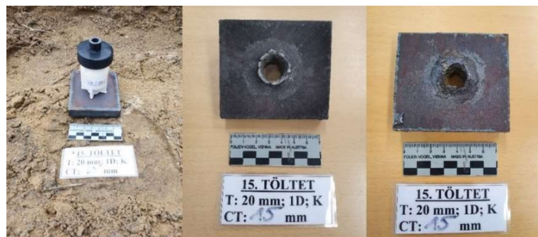
79. ábra: A 15. töltet a céltárgyon rögzítve, a robbantás után a céltárgy teteje és alja Forrás: a szerző szerkesztése.
