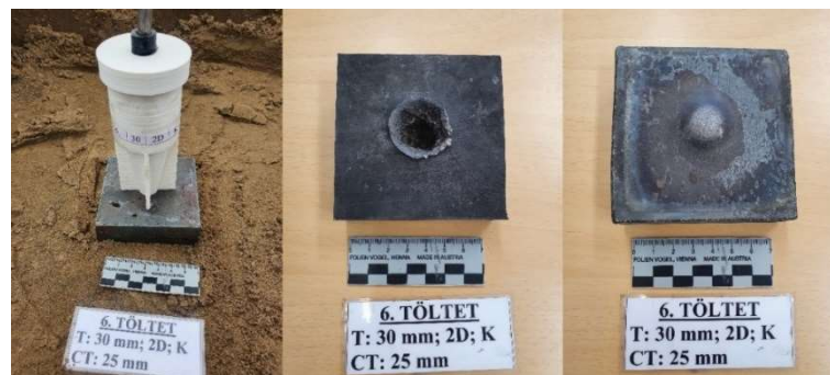
70. ábra: A 6. töltet a céltárgyon rögzítve, a robbantás után a céltárgy teteje és alja
