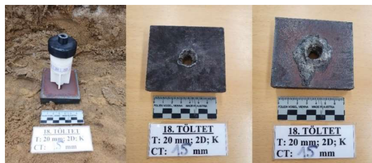
82. ábra: A 18. töltet a céltárgyon rögzítve, a robbantás után a céltárgy teteje és alja
