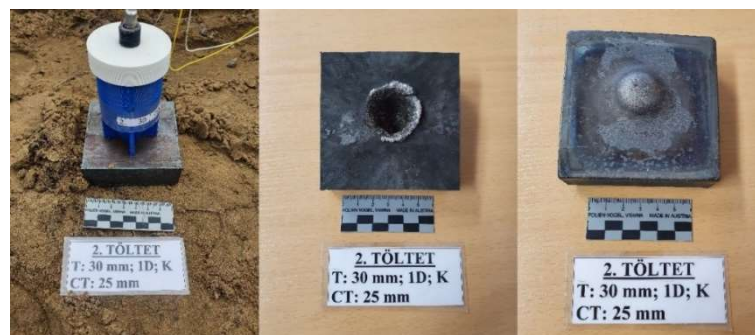
66. ábra: A 2. töltet a céltárgyon rögzítve, a robbantás után a céltárgy teteje és alja Forrás: a szerző szerkesztése.
