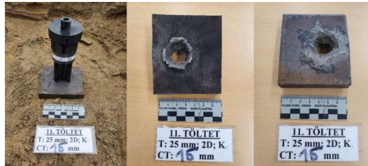
75. ábra: A 11. töltet a céltárgyon rögzítve, a robbantás után a céltárgy teteje és alja
