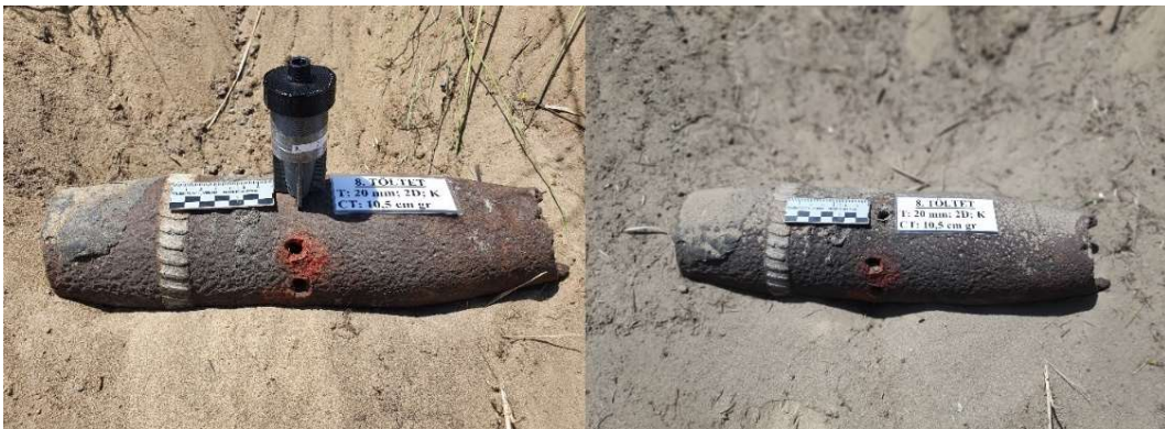
91. ábra: A 8. töltet a céltárgyon rögzítve és a kialakult lyuk a robbantás után
