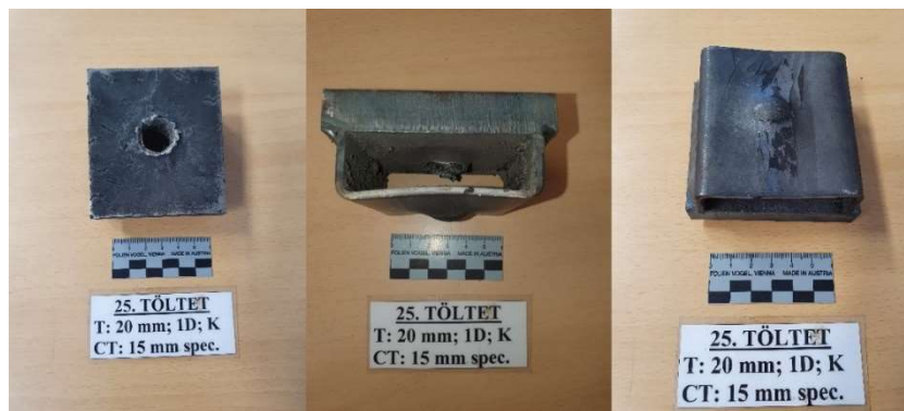
98. ábra: A 25. töltet céltárgya felülről, oldalról és alulról a robbantás után
