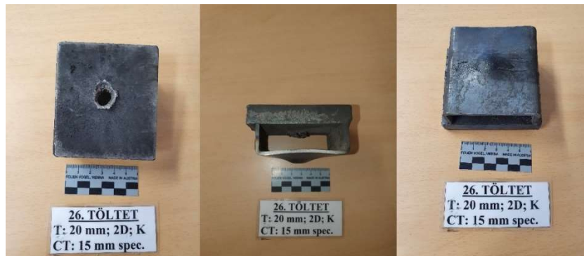
99. ábra: A 26. töltet céltárgya felülről, oldalról és alulról a robbantás után
