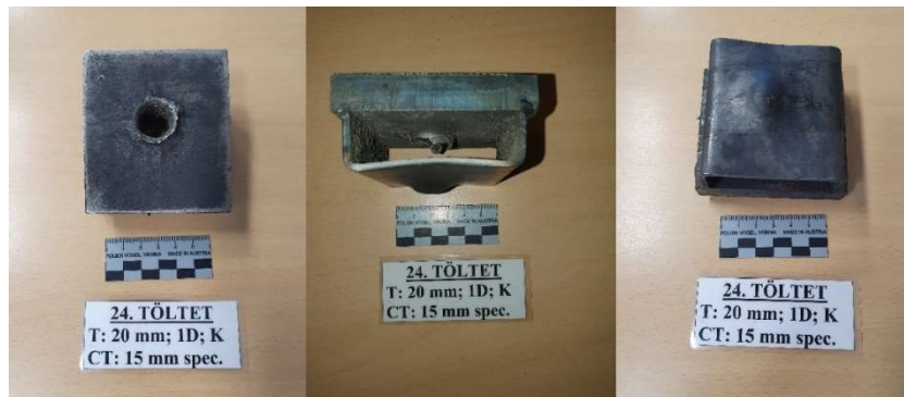
97. ábra: A 24. töltet céltárgya felülről, oldalról és alulról a robbantás után
