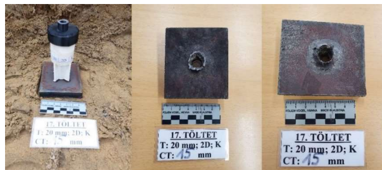
81. ábra: A 17. töltet a céltárgyon rögzítve, a robbantás után a céltárgy teteje és alja
