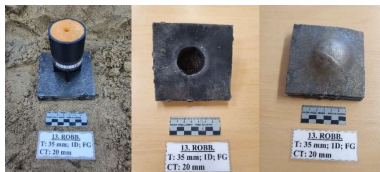
53. ábra: A 13. töltet a céltárgyon rögzítve, a céltárgy robbantás után megtalált legfelső és legalsó lemeze
