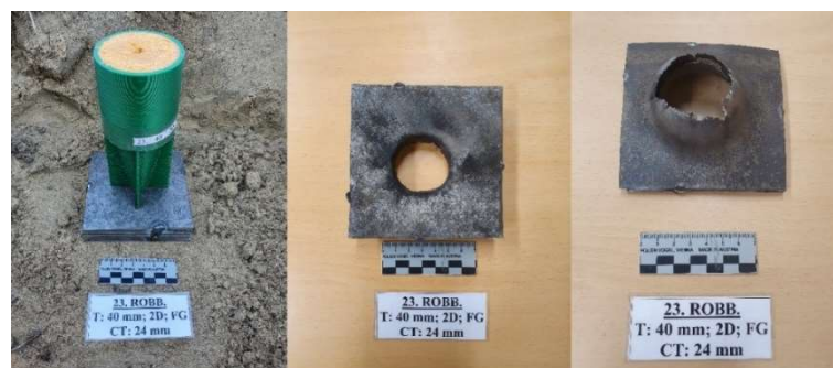
63. ábra: A 23. töltet a céltárgyon rögzítve, a céltárgy robbantás után megtalált legfelső és legalsó lemeze
