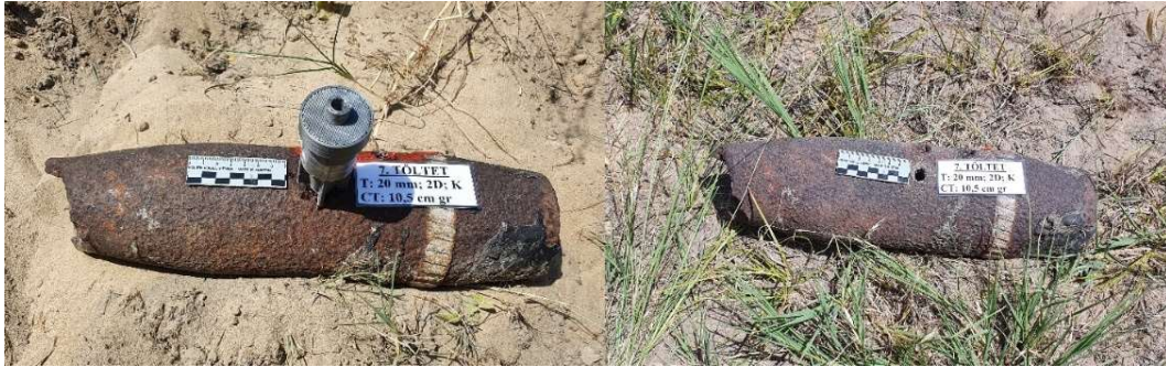
90. ábra: A 7. töltet a céltárgyon rögzítve és a kialakult lyuk a robbantás után
