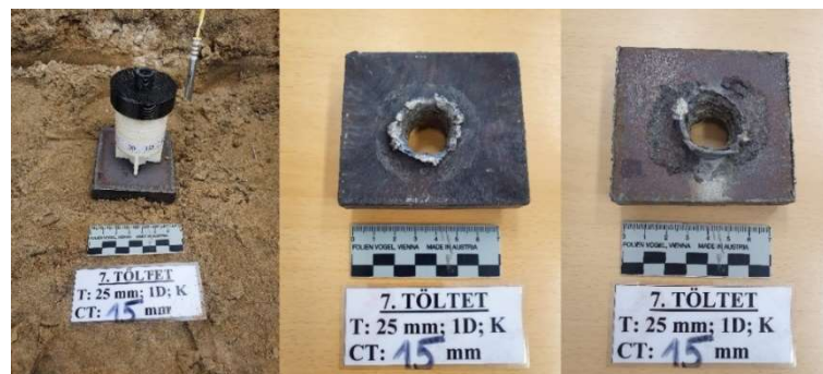
71. ábra: A 7. töltet a céltárgyon rögzítve, a robbantás után a céltárgy teteje és alja Forrás: a szerző szerkesztése.
