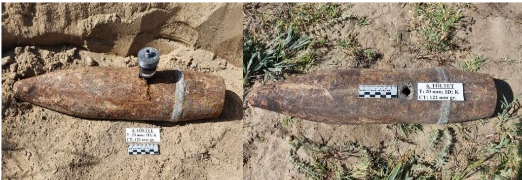
89. ábra: A: 6. töltet a céltárgyon rögzítve és a kialakult lyuk a robbantás után
