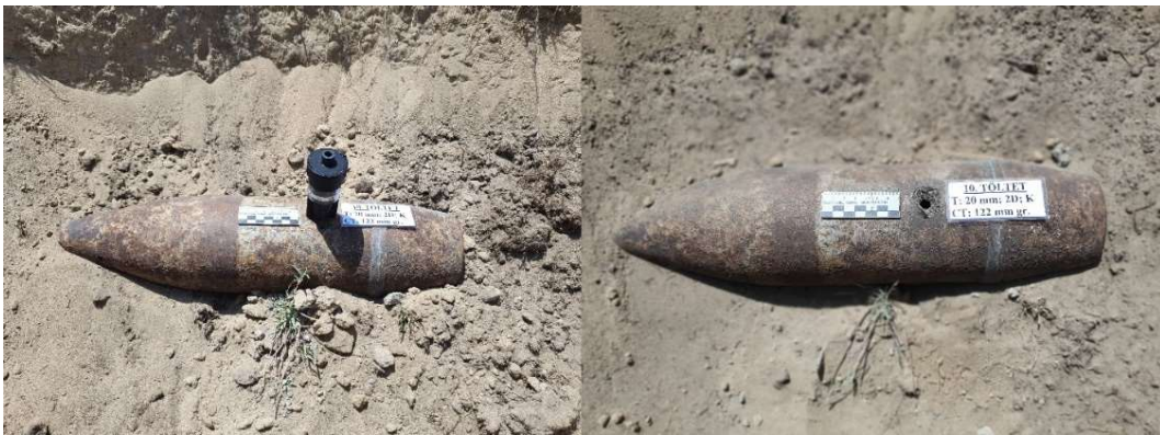
93. ábra: A 10. töltet a céltárgyon rögzítve és a kialakult lyuk a robbantás után
