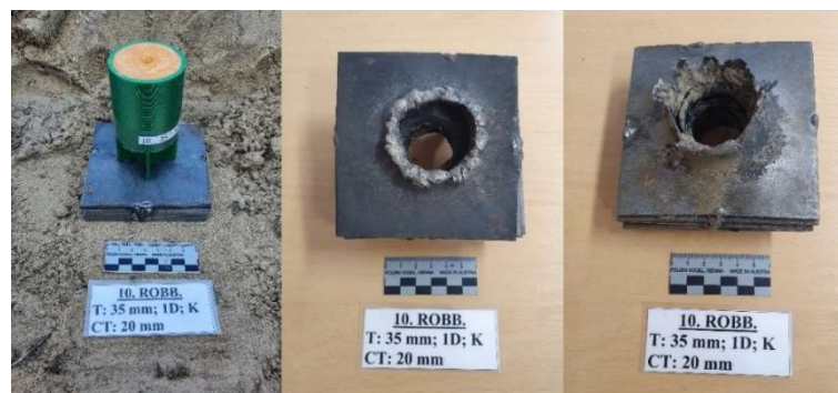
50. ábra: A 10. töltet a céltárgyon rögzítve, a céltárgy robbantás után megtalált legfelső és legalsó lemeze
