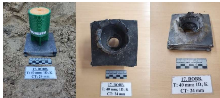
57. ábra: A 17. töltet a céltárgyon rögzítve, a céltárgy robbantás után megtalált legfelső és legalsó lemeze
