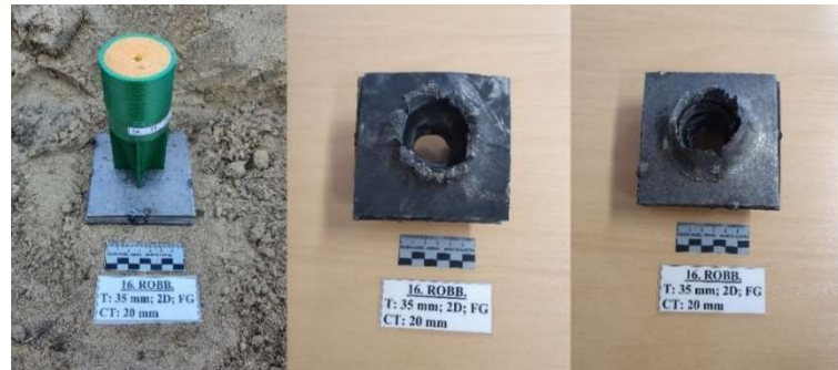
56. ábra: A 16. töltet a céltárgyon rögzítve, a céltárgy robbantás után megtalált legfelső és legalsó lemeze
