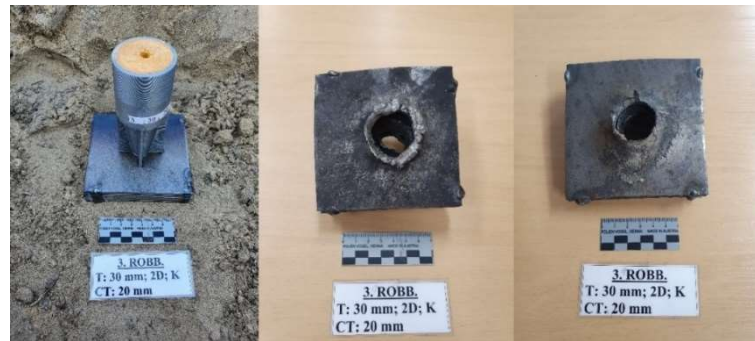
43. ábra: A 3. töltet a céltárgyon rögzítve, a céltárgy robbantás után megtalált legfelső és legalsó lemeze Forrás: a szerző szerkesztése.
