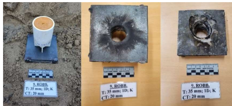
49. ábra: A 9. töltet a céltárgyon rögzítve, a céltárgy robbantás után megtalált legfelső és legsó lemeze Forrás: a szerző szerkesztése.
