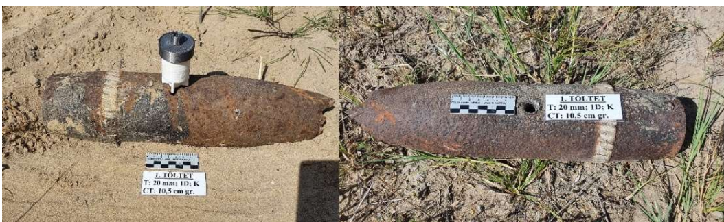
84. ábra: Az 1. töltet a céltárgyon rögzítve és a kialakult lyuk a robbantás után
