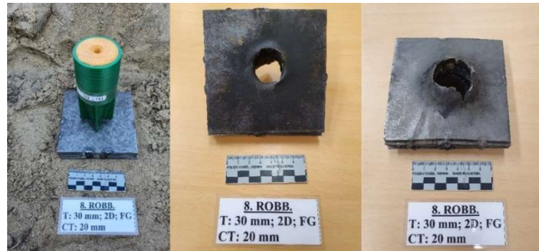
48. ábra: A 8. töltet a céltárgyon rögzítve, a céltárgy robbantás után megtalált legfelső és legsó lemeze Forrás: a szerző szerkesztése.
