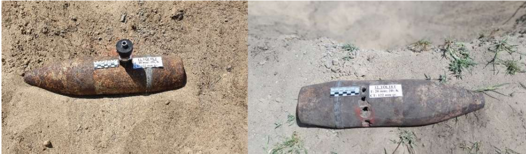
95. ábra: A 12. töltet a céltárgyon rögzítve és a kialakult lyuk a robbantás után
