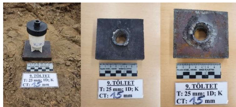
73. ábra: A 9. töltet a céltárgyon rögzítve, a robbantás után a céltárgy teteje és alja Forrás: a szerző szerkesztése.
