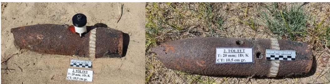
85. ábra: A 2. töltet a céltárgyon rögzítve és a kialakult lyuk a robbantás után
