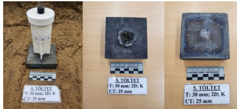
69. ábra: Az 5. töltet a céltárgyon rögzítve, a robbantás után a céltárgy teteje és alja
