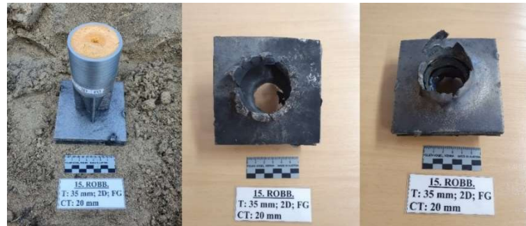
55. ábra: A 15. töltet a céltárgyon rögzítve, a céltárgy robbantás után megtalált legfelső és legelső lemeze
