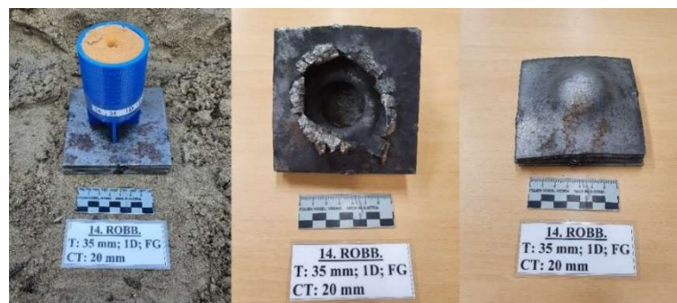
54. ábra: A 14. töltet a céltárgyon rögzítve, a céltárgy robbantás után megtalált legfelső és legalsó lemeze
