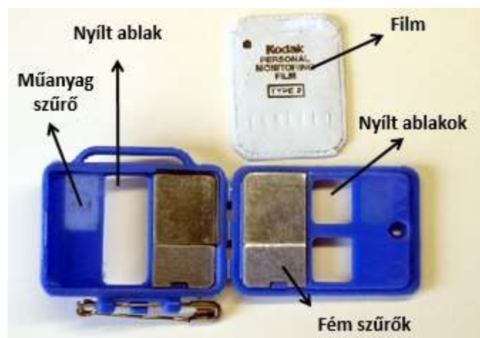
13. ábra: Filmdózismérő felépítése [7]
