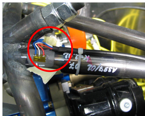
9. ábra A motortartó bakon elhelyezett nyúlásmérő bélyeg
