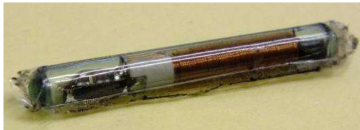
1. ábra. 32 mm-es transzponder beépítése előtt (Fotó: Berek)
