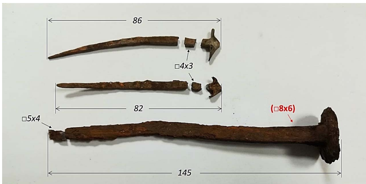
4. ábra: A vizsgált vasszegek, a minták leválasztása után. A méretek az eredeti hosszra vonatkoznak.
