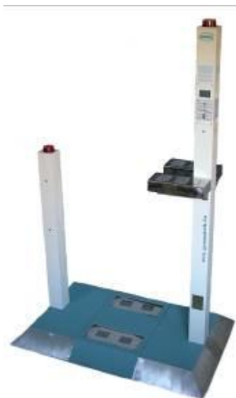
4. ábra. BNS-94PH Hibrid sugárkapu személyek ellenőrzésére (forrás: BNS-98 Műszaki Dokumentáció, Gamma Műszaki zRt.)
