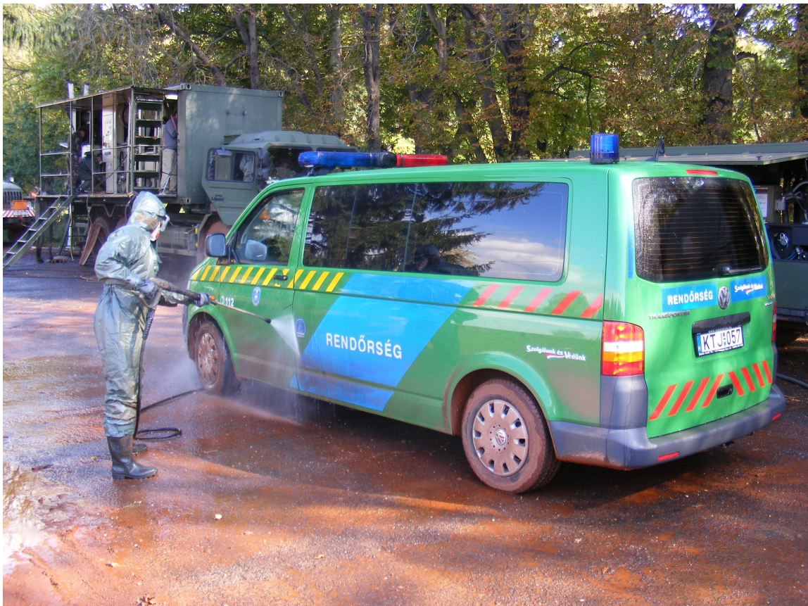
2. ábra. A katasztrófaelhárításban résztvevő rendőrautó mentesítése DECOCONTAIN-3000 ELS mentesítő konténerrel a devecseri Kastélypark melletti telepített mentesítőhelyen
