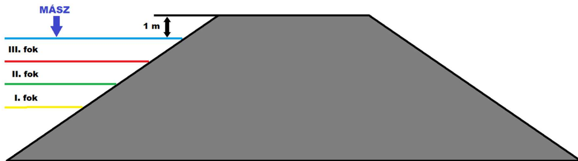
17.ábra: A Telephely Hidrológiai jellemzés és árvízvédelmi jegyzet előírás szerint kialakított árvízvédelmi töltés a mértékadó árvíz-szint jelölése, forrás: Készítette a szerző [106]
