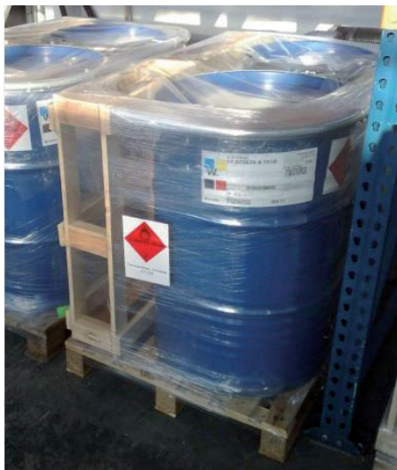
74. ábra A hordó megfelelő rögzítése raklapon 18
