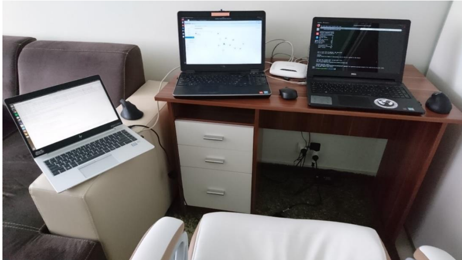
20. ábra: A számítógépek és a router (balról jobbra): a szimulátort futtató gép, az „uascontrolnode” gép, a router és az „uascomputenode1” gép. (A képet készítette a szerző.)
