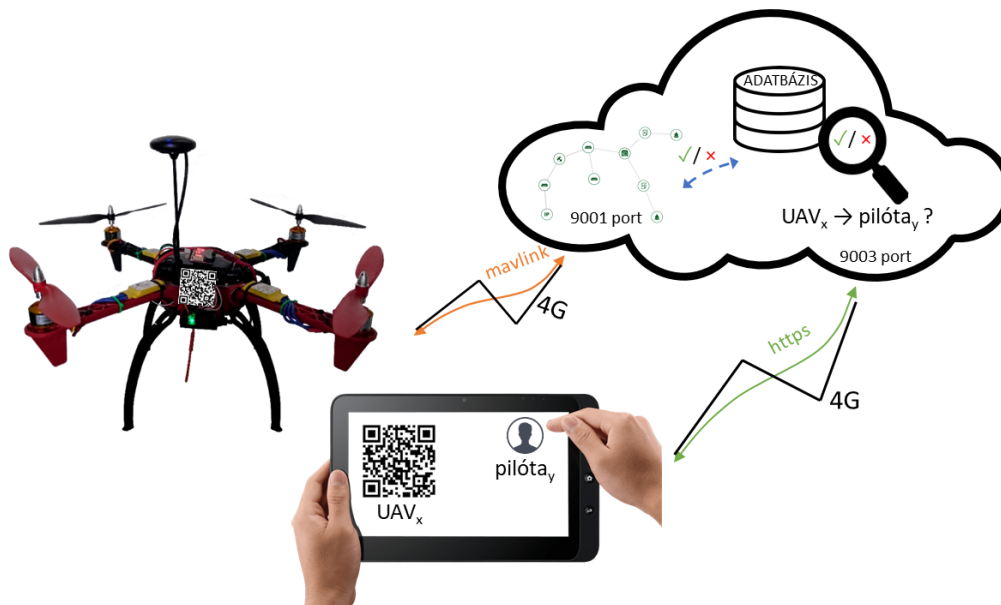
33. ábra: QR-kód alapú UAV aktiválás interneten át. (Az ábrát szerkesztette a szerző.)
