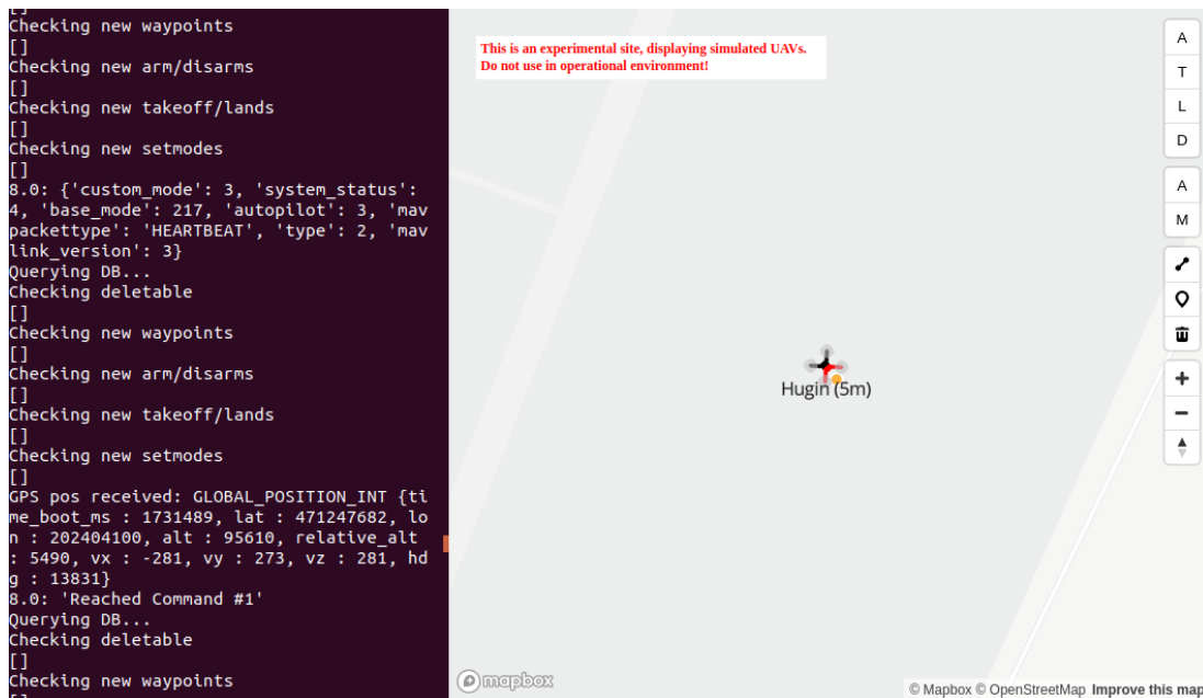
24. ábra: A szerveroldali konzol a napló néhány sorával, illetve a térképes felület autonóm repültetés közben. A narancssárga pont jelöli az úti célt. A bal oldali konzol ablakban látható egy nyers státuszüzenet és egy pozícióüzenet koordinátákkal, magasság- és egyéb repülési adatokkal, majd a visszajelzés, miszerint a légitármű elérte az első számú úticélt. (A képernyőképet készítette a szerző.)
