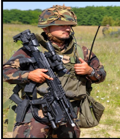
5. számú kép. AMD gépkarabély továbbfejlesztett változata (amerikai kiegészítésekkel modernizált, alul gránátvető, alatta nagy fényerejű lámpa, Tetején optikai irányzék) (Készítette: Rácz Tünde)
