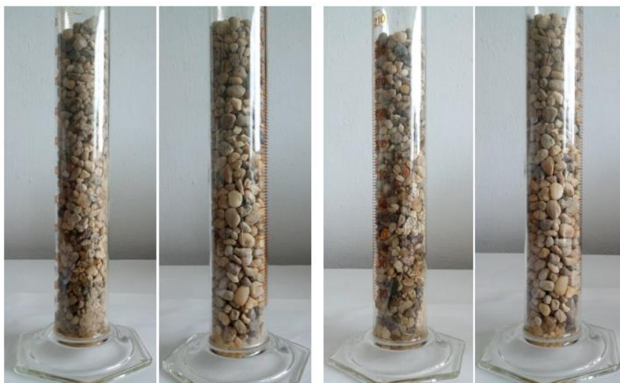
4. kép. Tűzoltóhab beszivárgása 4/8 kavics adalékanyagba, készítette: Szabó Henrietta, NKE VTK 2019.
