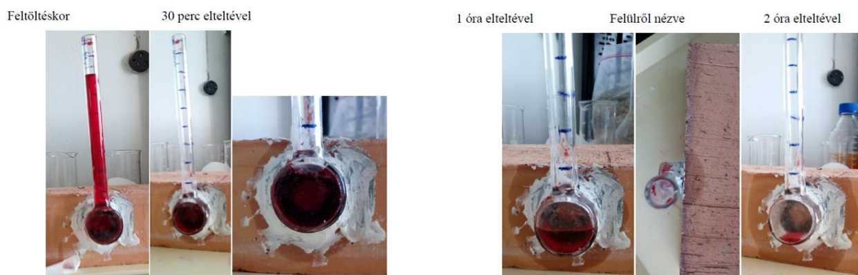
1. kép: Víz beszivárgás mértéke téglá esetében, készítette: Szabó Henrietta, NKE VTK 2019..
