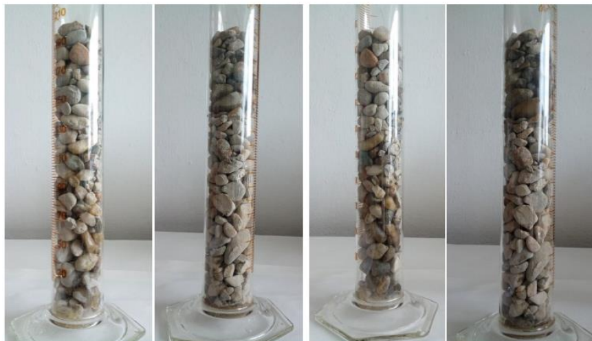
3. kép: Tűzoltóhab beszivárgása 8/16 kavics adalékanyagba, készítette: Szabó Henrietta, NKE VTK 2019.
