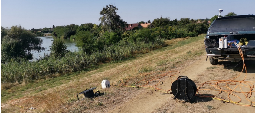
14. ábra: A fajlagos ellenállásmérő mérés közben
