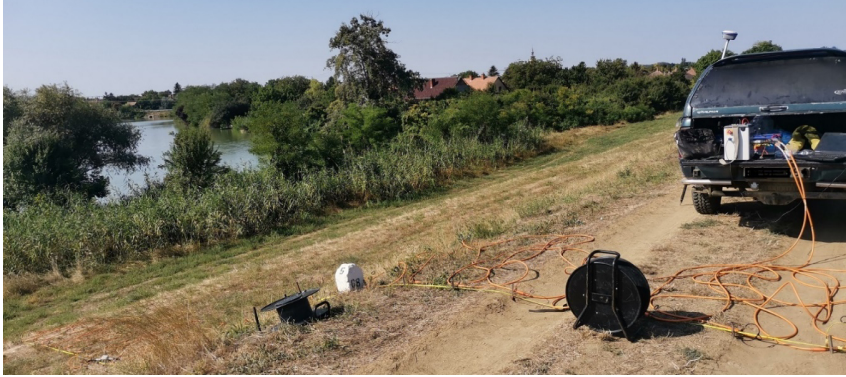
14. ábra: A fajlagos ellenállásmérő mérés közben
