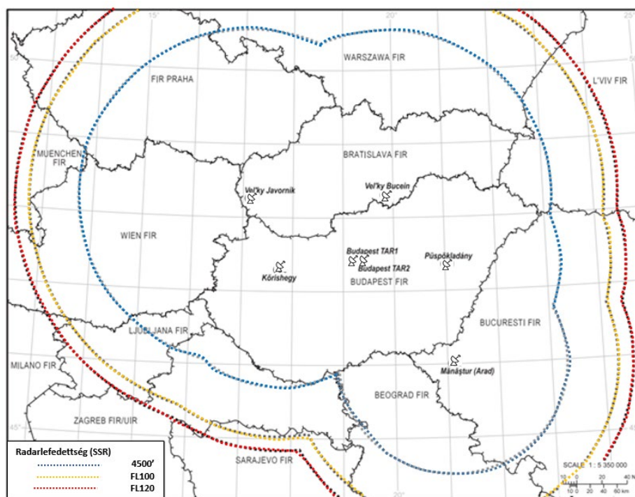
13. ábra: Másodlagos radarok felderítési karakterisztikája (Szerkesztette a szerző. Forrás: AIP Hungary [130])
