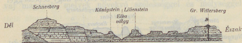
1:50,000. A magasságok a hossz mérték tizszeresei. 88. ábra. A Szász Svájc kockakohomokkő rétegeinek metszete Hochstetter után. Gn = gneisz, B = bazalt, 1-4 = felfelé mind lazább homokkőrétegek.
