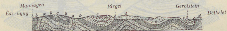
85. ábra. Az Eifel metszete Hann után. (1:50,000) A magasságok a hossz mérték tízszeresei. a = szürke agyag, b = pala, c = mész, d = tarka homokkő.
