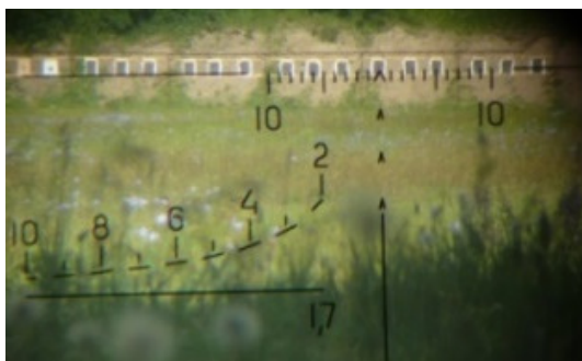
61. ábra: Az 1960-as években rendszeresített SZVD távcsöves puska PSZO-1 optikai irányzékának 249 irányzójele (a képen balra) megvilágítható és vonás alapján alkalmas távolságbecslésre 250
