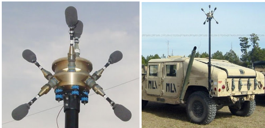
67. ábra: A Boomerang érzékelő modulja külön és járműre telepítve 311
