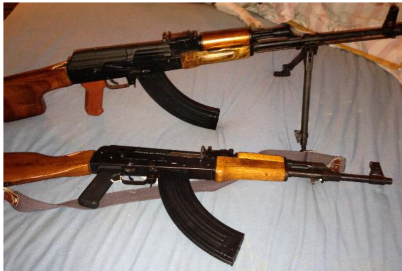
49. ábra: Az RPK golyószóró és az AKM gépkarabély: a lőszer és a tár azonos 194
