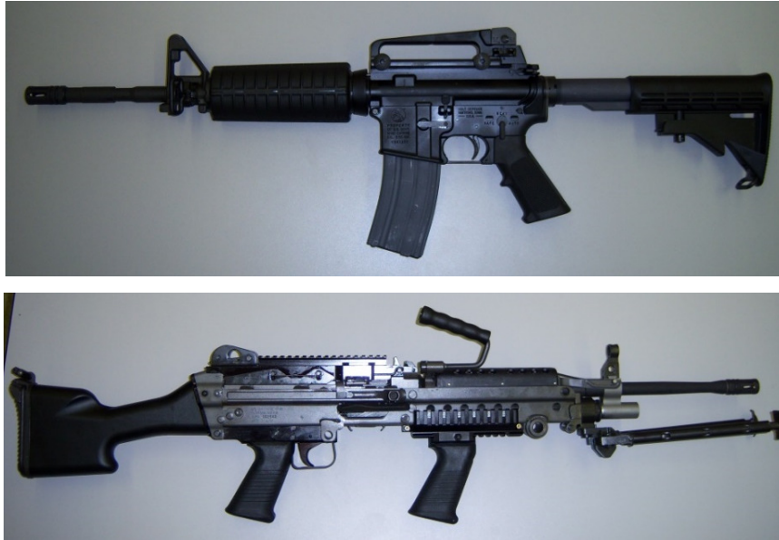
50. ábra: Az M4A1 gépkarabély és az M249 könnyű géppuska: a lőszer és a tár azonos 195
