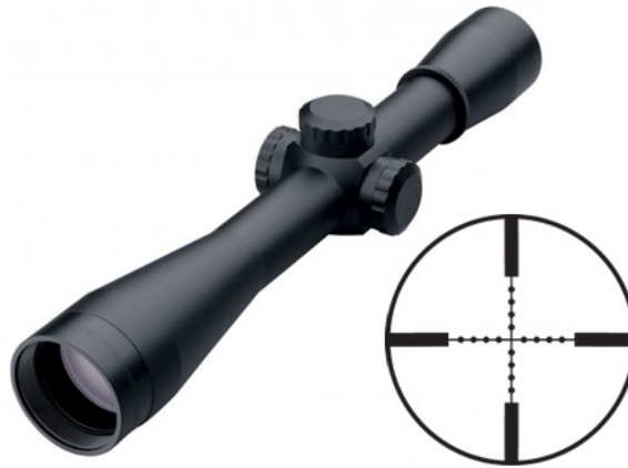
62. ábra: Az MH-ban is használt M24A1 mesterlövészpuskához rendszeresített Leupold M3 céltávcső szátkeresztje milliradián alapján távolságbecslésre alkalmas, de nem megvilágítható 254
