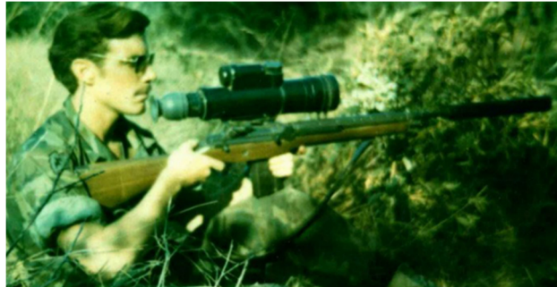
13. ábra: Az M21 távcsöves öntöltő puska AN/PVS-2 éjszakai irányzékkal és Sionics hangtompítóval 60
