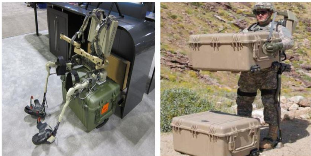
3. kép: A HULC rendszer vázszerkezete és annak használata. Forrás: [230]
