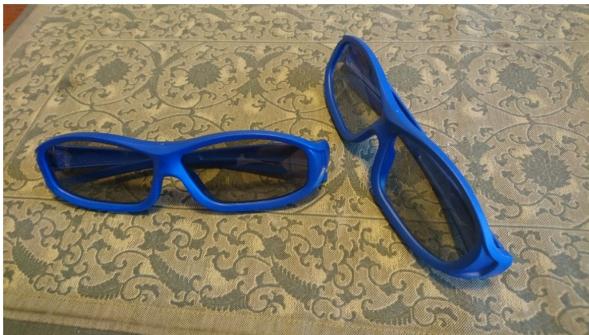
2.2. ábra. Sztereoszkóp szemüvegek filmszínházi felhasználásra. A moziban egyidejűleg két filmet vetítenek a vászonra, a speciális, úgynevezett polarizációs szűrős szemüvegek biztosítják, hogy mindkét szem a számára vetített, kissé különböző nézőpontból készült képet lássa
