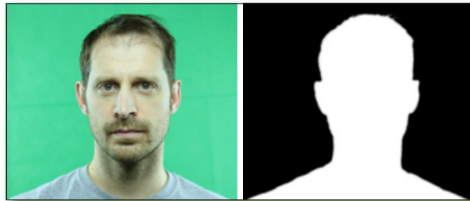
6.1. ábra Zöld háttér előtt készített felvétel (balra), és a szín alapján készített maszk.
