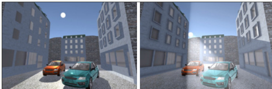
4.10. ábra Összetett színtér árnyéksávok nélkül (balra), és árnyéksávok hozzáadásával (jobbra).
