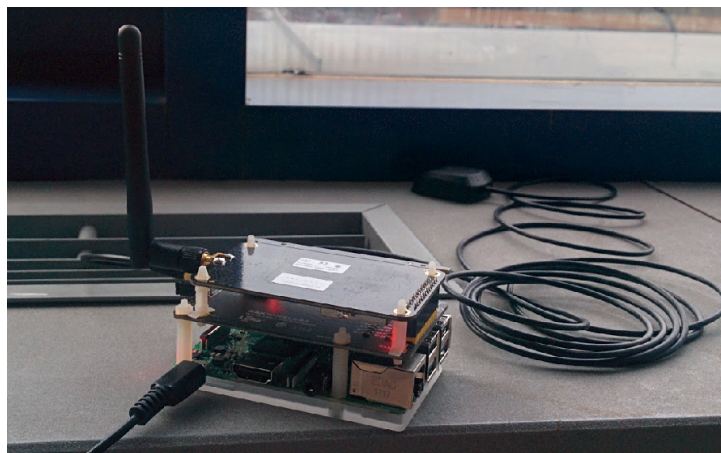
5.8 ábra: LoRaWAN átjáró RaspberryPi alapon és GPS vevő a Class B ütemezéshez.
