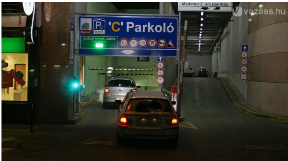
3.1 ábra. Sorompó és a szabad helyek számát mutató kijelző a Mammut bevásárlóközpont mélygarázsánál, Budapesten
