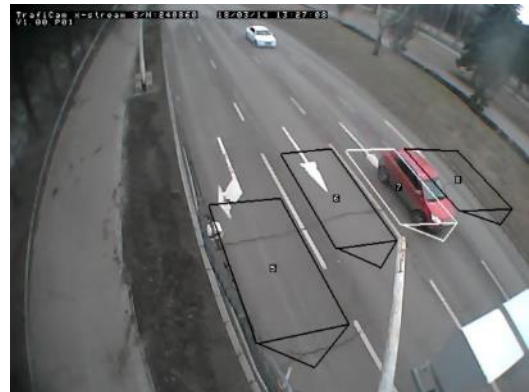
4.2. ábra. Kihelyezett FLIR Traficam x-stream forgalomfigyelő kamera, illetve az általa annotált videostream, a különböző forgalmi sávokban felismert járművekkkel
