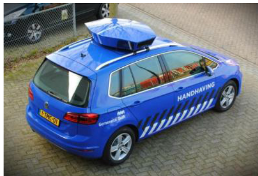
3.4. ábra. Kamerákkal felszerelt, parkolást ellenőrző jármű Hollandiában
