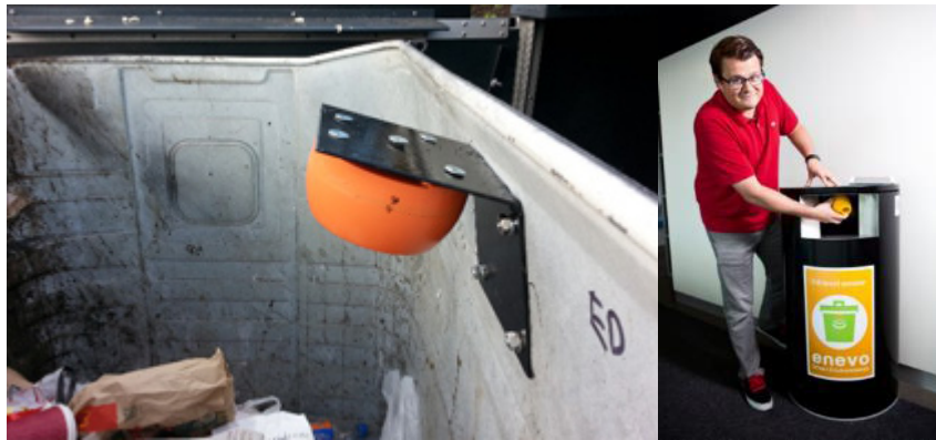
5.2. ábra. Az Enevo által gyártott, szemetes kukák telítettségét mérő szenzorok
