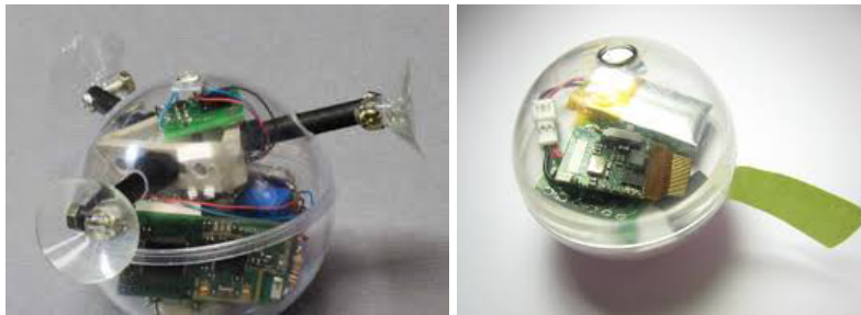
5.1. ábra. A taivani egyetem kutatói által fejlesztett Triopus szenzor vízhatlan dobozolása és tapadókorongokkal felszerelt lábai, illetve a motorral nem rendelkező PipeProbe szenzor
