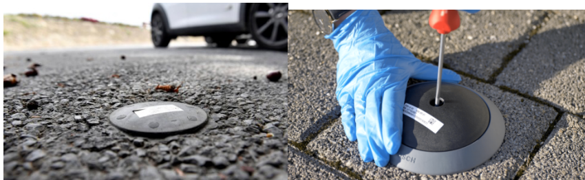
3.3. ábra. Az aszfaltcsíkba illesztett szenzor Szentendrén, illetve az újabb megoldás, amikor az aszfalt tetejére rögzítik a szenzort
