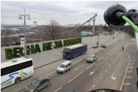
4.2. ábra. Kihelyezett FLIR Traficam x-stream forgalomfigyelő kamera, illetve az általa annotált videostream, a különböző forgalmi sávokban felismert járművekkkel
