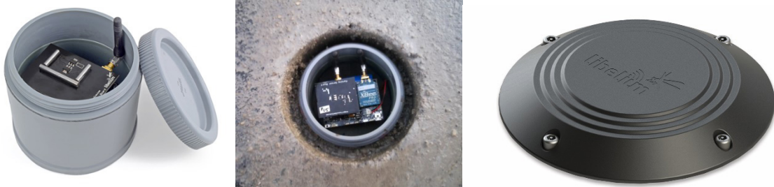
2.5. ábra. Burkolatba helyezhető parkolásszenzorok a Libeliumtól
