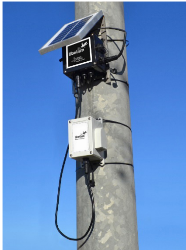
2.1. ábra. A Libelium cég környezet megfigyelő szenzora lámpaoszlopra szerelve
