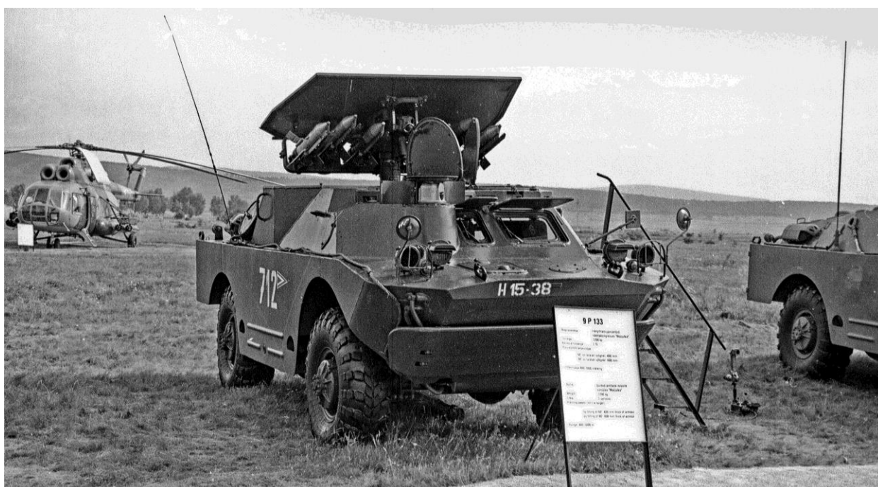
32. kép 9P133 „Maljutka-P” páncéltörő rakétaindító harcjármű
