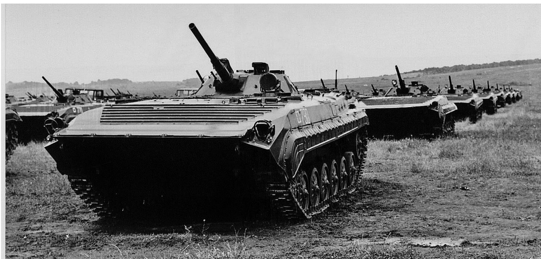
4. kép BMP–1 típusú gyalogsági harcjármű
