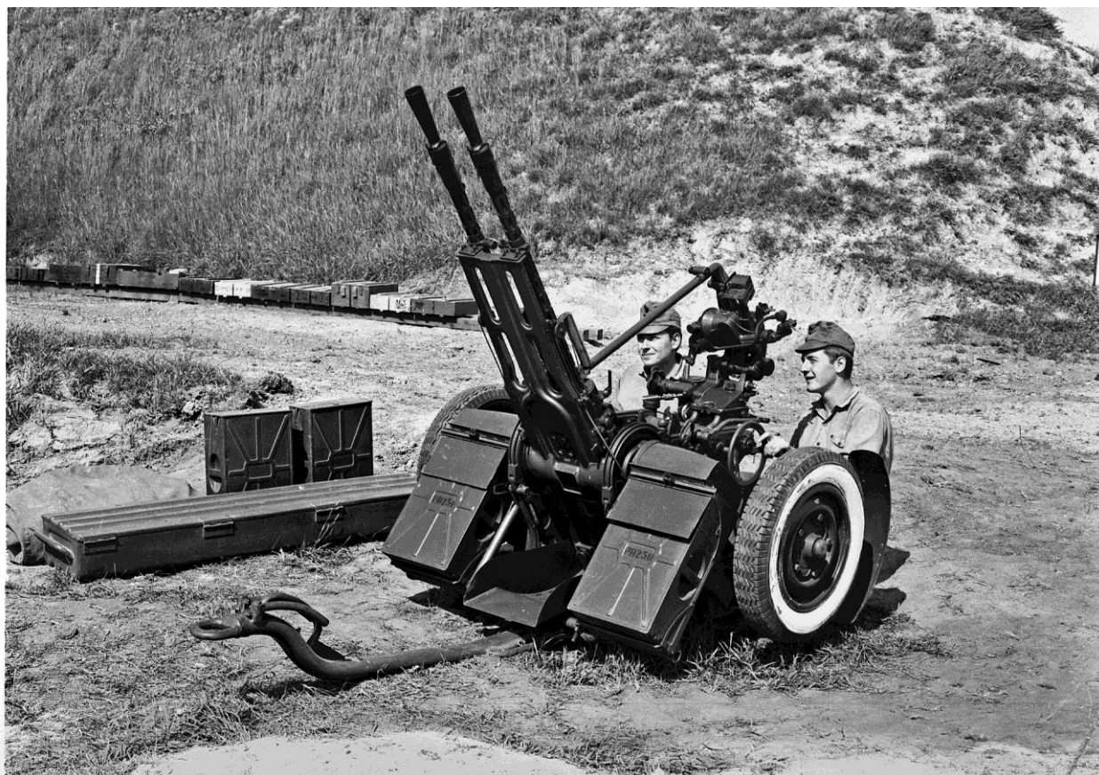
34. kép 14,5 mm-es ZU–2 ikercsövű légvédelmi géppuska
