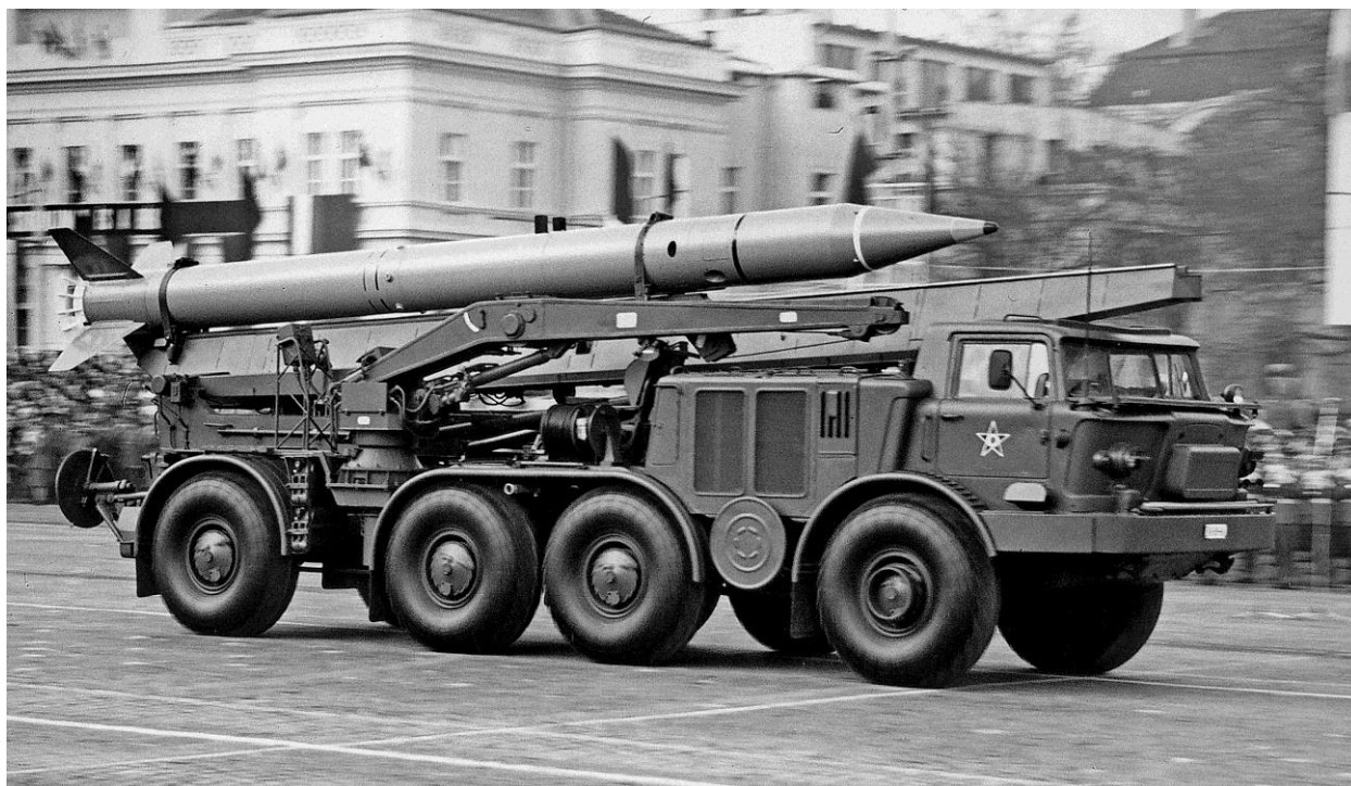
17. kép 9K52 Luna-M harcászati rakétakomplexum 9P113M típusú indítóállványa
