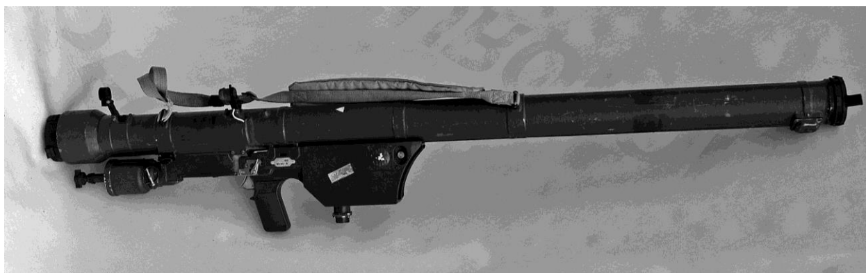
41. kép 9K32M Sztrela–2M közeli hatótávolságú légvédelmi rakétarendszer rakétaindító konténere, indítómechanizmussal
