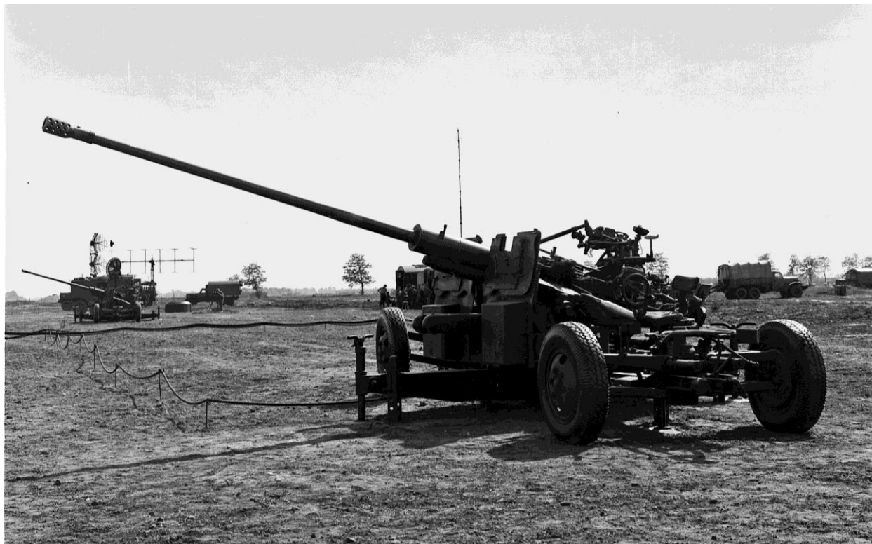
38. kép 57 mm-es Sz-60 légvédelmi gépágyú
