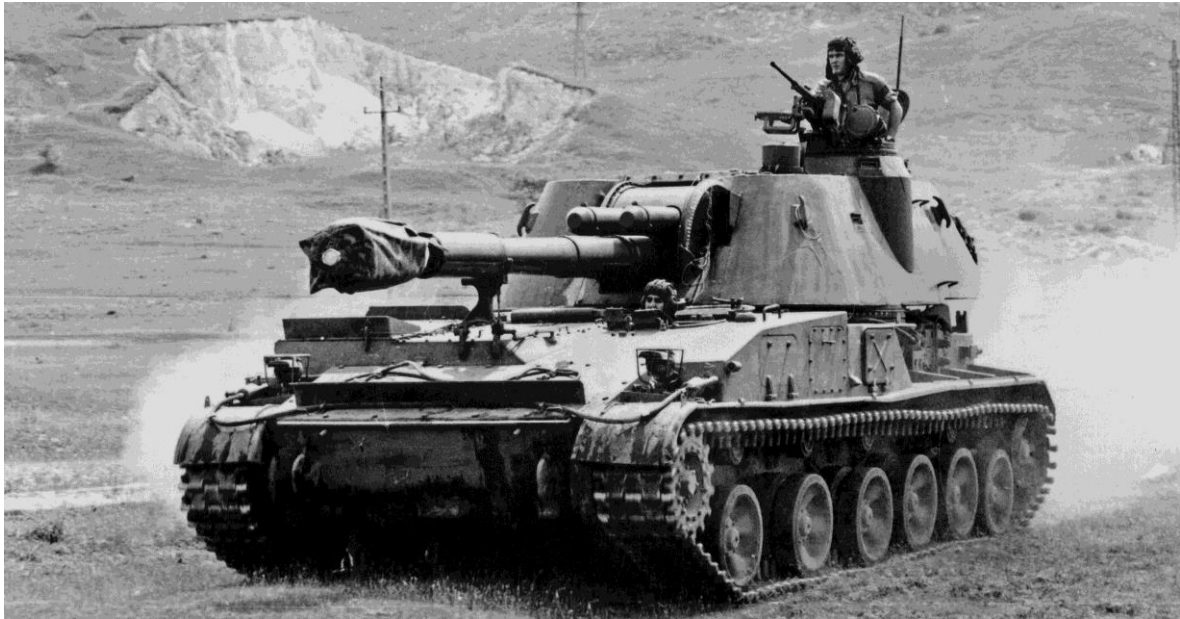
23. kép 152 mm-es 2SZ3M Akácija önjáró tarack
