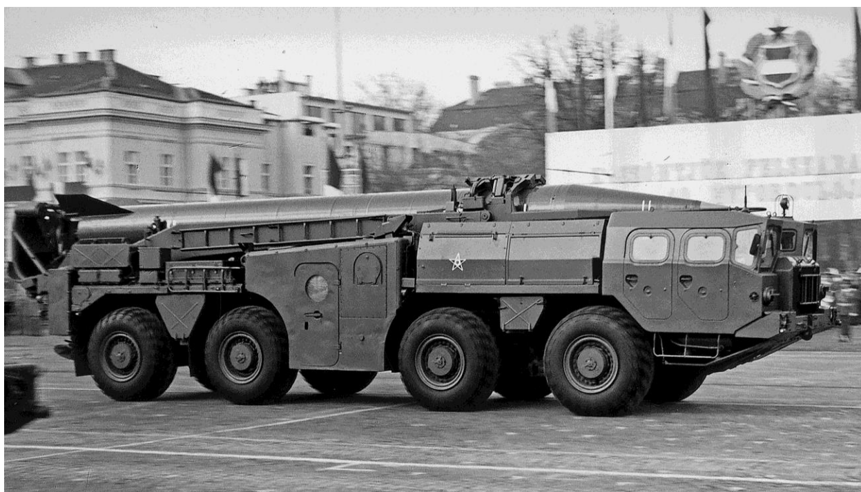
16. kép 9K72 hadműveleti-harcászati rakétakomplexum 9P117M1 típusú indítóállványa
