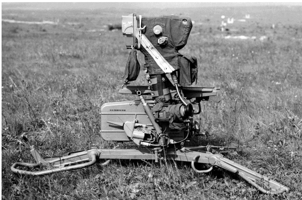
31. kép 9K111 Fagot kézi irányított páncéltörő rakétarendszer 9P135 típusú indítóállványa
