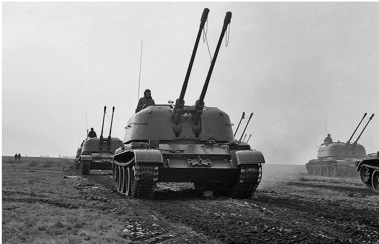
37. kép 57 mm-es ZSzu–57–2 Búszke típusú önjáró légvédelmi gépágyú
