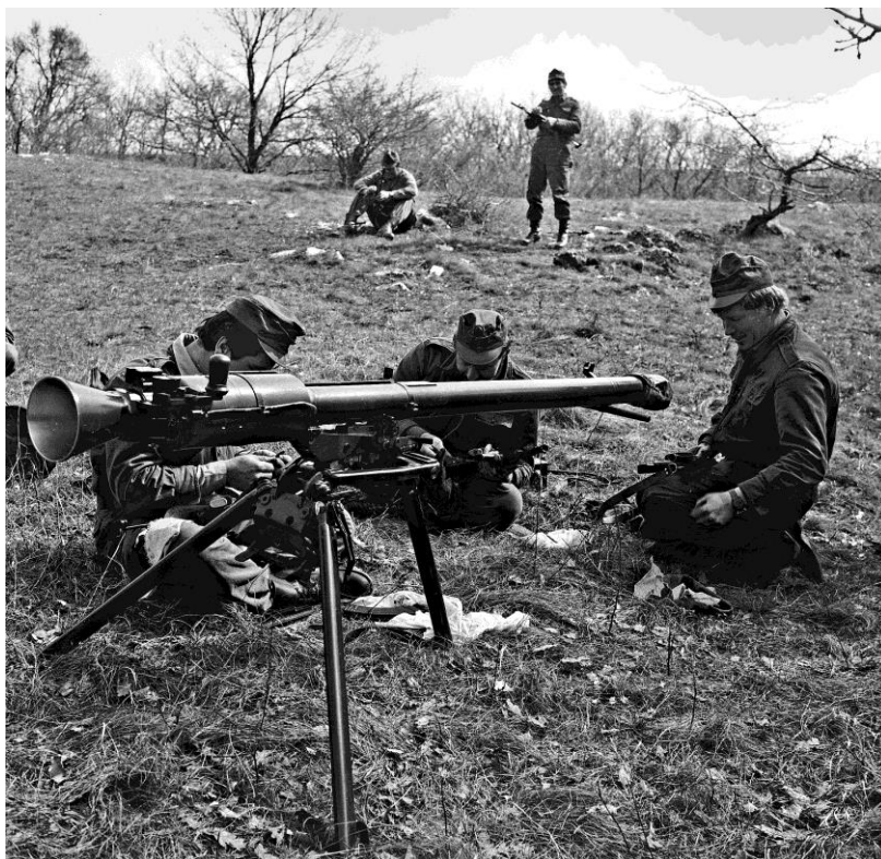
28. kép 73 mm-es SzPG–9D állványos gránátvető
