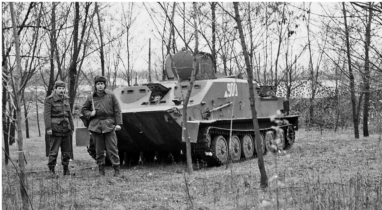
7. kép BTR–50PU típusú páncélozott vezetési pont
