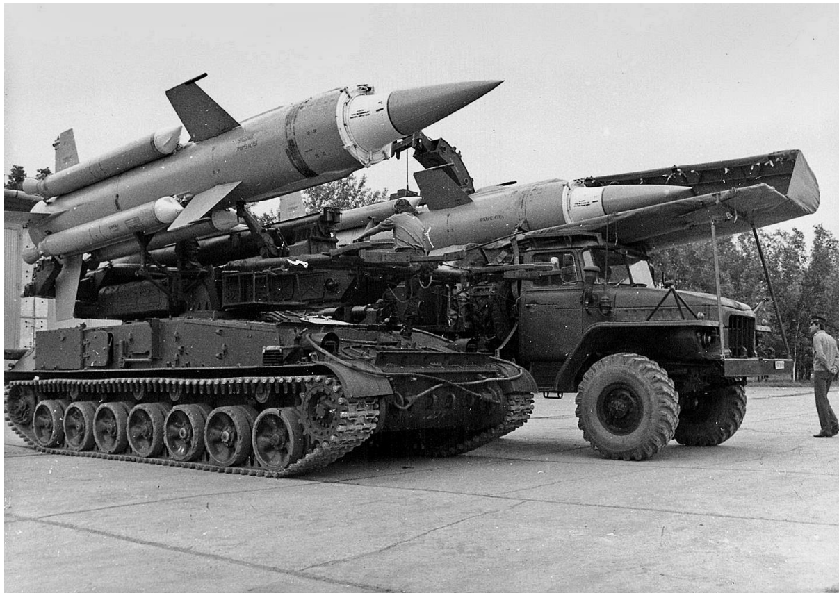
44. kép 2K11 Krug típusú önjáró légvédelmi rakétakomplexum 2P24M1 önjáró indítóállványa
