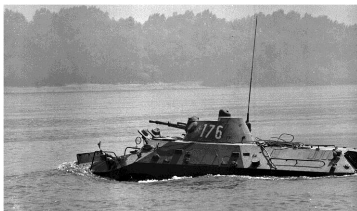
1. kép D–944 PSZH páncélozott szállító harcjármű
