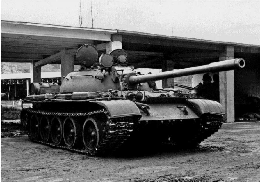
11. kép T-55 típusú közepes harckocsi
