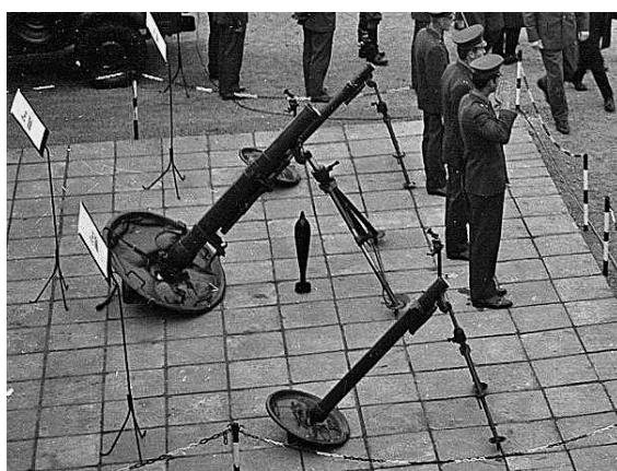
26. kép 82 mm-es 37M és 120 mm-es 43M aknavetők
