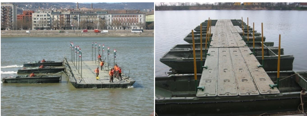
32. számú ábra – PMP szalaghíd [73; 131] valamint KD-84 desszantátkelő [73; 133] alkalmazás közben
