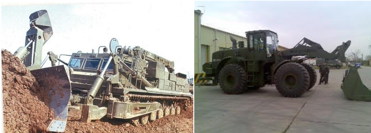
33. számú ábra – BAT-2 [85] gyorsjáratú lánctalpas buldózer és Hyundai HL770-7A [73; 128] földmunkagép
