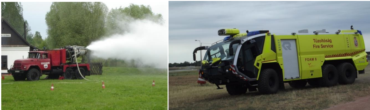
27. számú ábra – Zil-131 turboreaktív oltógépjármű [74] valamint Rosenbauer Panther 6x6repülőtéri habbal-oltó gépjármű [75]
