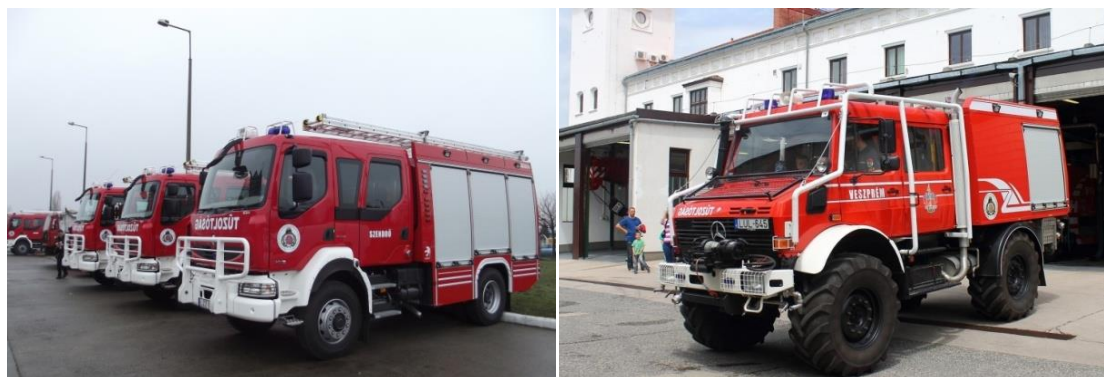
26. számú ábra – Renault Midlum 300 [72] gépjárműfecskendő és Mercedes Unimog Forester [73] erdőtűzes gépjármű
