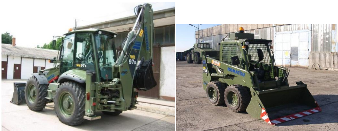
34. számú ábra – Közepes- és kisteljesítményű Komatsu [86][73; 130] univerzális földmunkagépek
