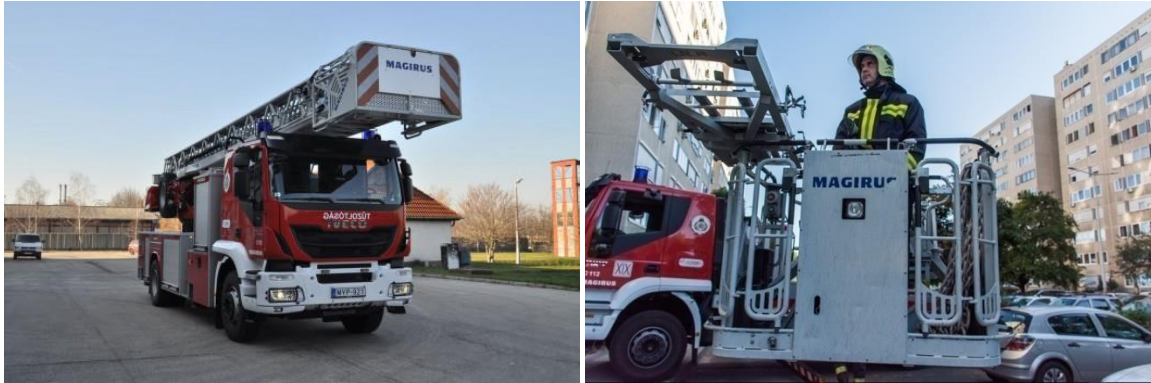
24. számú ábra– IVECO Magirus DLK 37 [69]emelőkosaras gépjármű valamint speciális hordágytartó kerettel magasból mentő [70]
