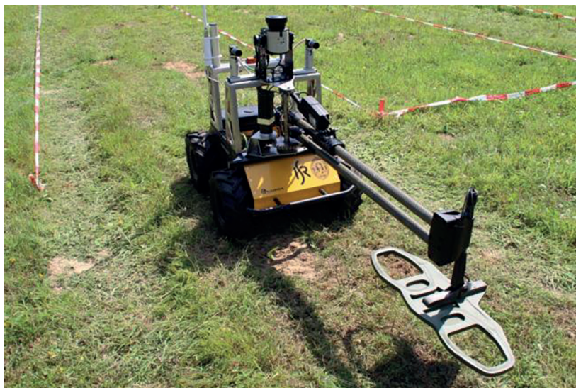
12. ábra. A Tiramisu amerikai aknafelderítő robot
