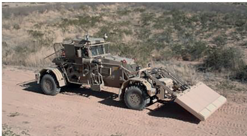
11. ábra. A Husky-2 amerikai aknakutató gépjármű
