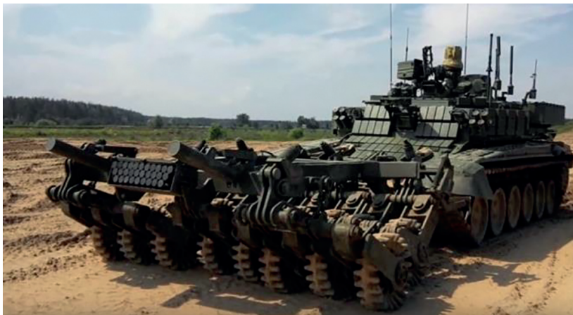
13. ábra. Az orosz Prokhod-1 aknamentesítő rendszer
