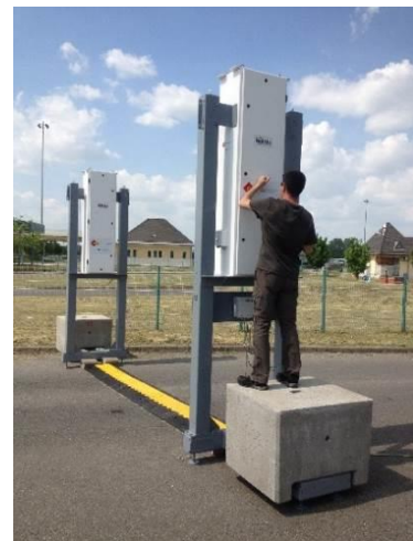
3. ábra: A francia fejlesztő áthelyezhető sugárérzékelő berendezése 218
