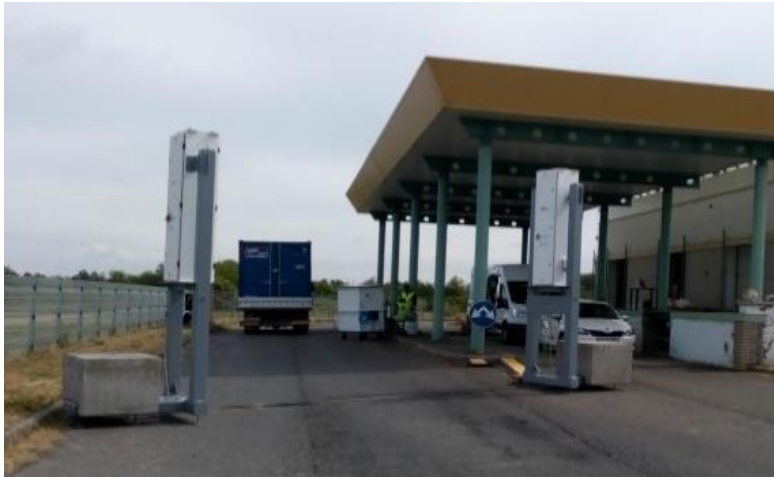
3. ábra: A francia fejlesztő áthelyezhető sugárérzékelő berendezése 218
