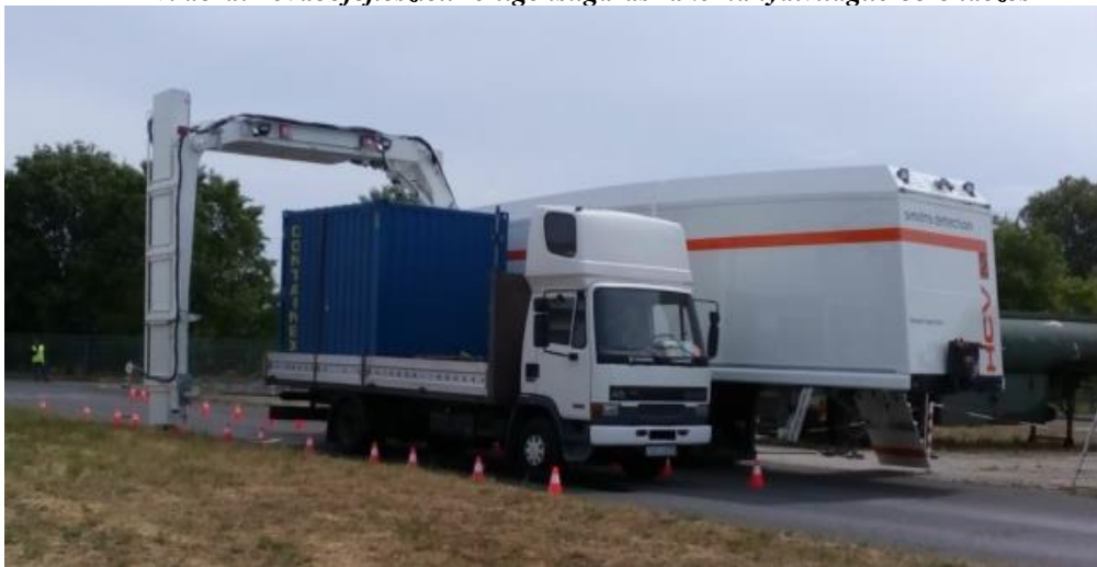
7. ábra: Továbbfejlesztett röntgensugaras rakományátvilágító berendezés 227
