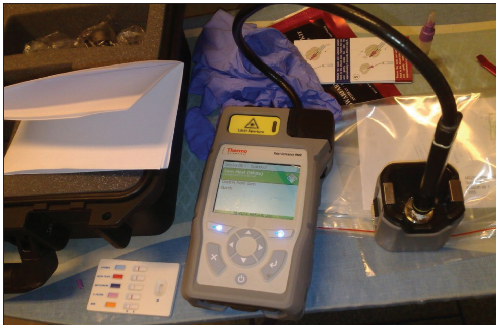
5. kép: FirstDefender eszköz helyszíni alkalmazása (forrás: BM OKF)
