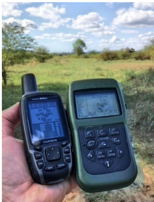
5. ábra: A quad helix antennával rendelkező Garmin GPSMAP 64st (balra) és a „láthatatlan” patch antennás Rockwell Collins DAGR (jobbra) külső megjelenése
