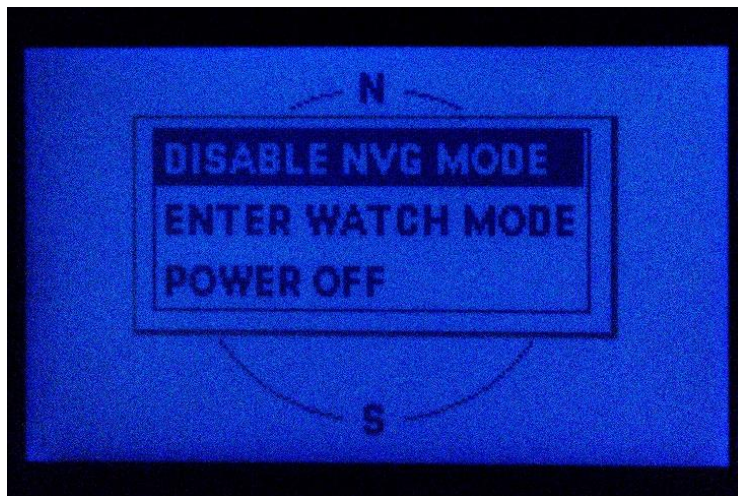
3. ábra: A katonai célú GPS vevőknél az éjjellátóval (NVG – Night Vision Goggles) kompatibilis kijelző alapkövetelmény
