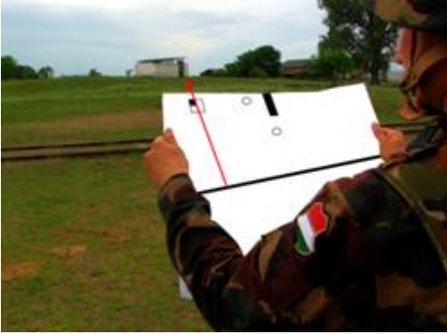
141. kép: Oldalmetszés vonalzóval. 8 Oldalmetszés. 9
