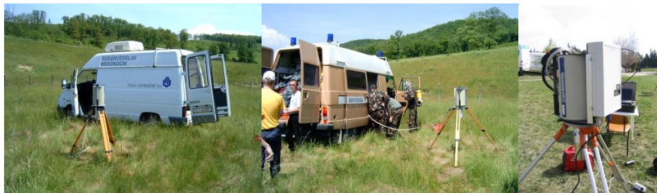
6. ábra Terepen végzett in-situ gamma-spektrometriai mérések [saját forrás]
