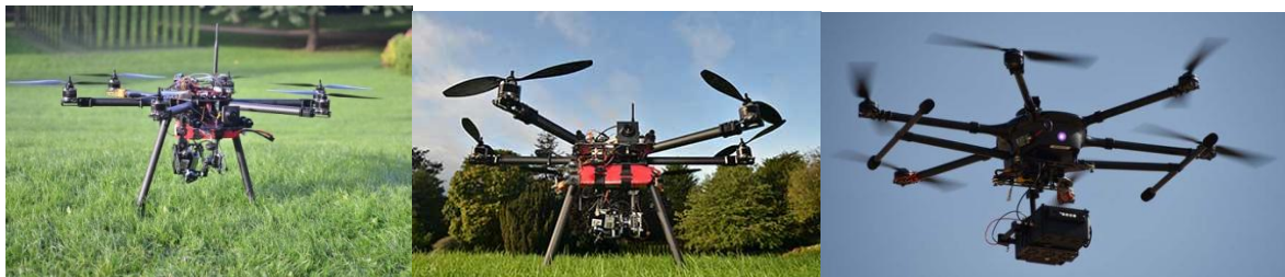
17. ábra Bristol Egyetem által fejlesztett speciális sugárfelderítő drónok [20, 21, 22]
