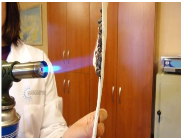
Слика 5. Формирање заштитног слоја бубрењем материјала када је изложен ватри
