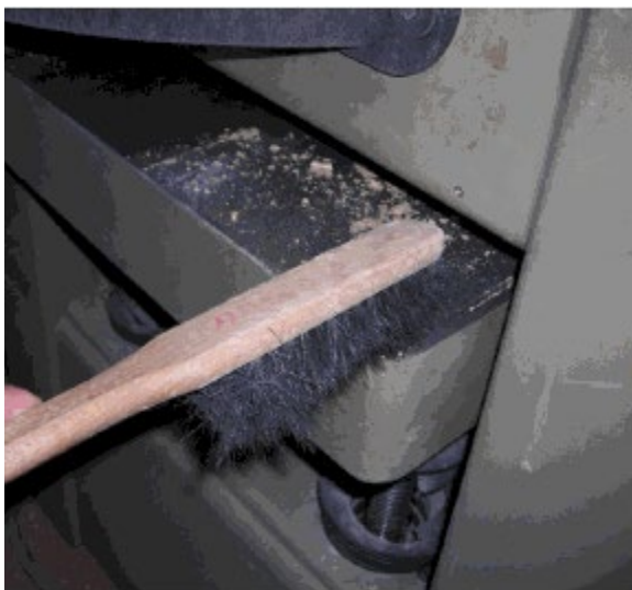
Слика 3. Уклањање струготине са радног стола четком, [4]
