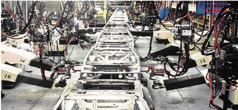
Слика 1. Аутоматизован процес производње у фабрици аутомобила [6]
