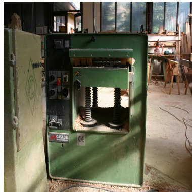
Слика 5. „NOT-STOP“ тастер у случају евентуалне опасности
