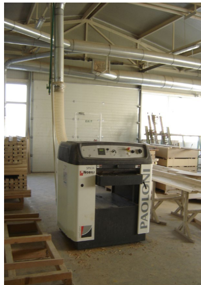
Слика 4. Прикључак на дебљачи за одвођење струготине, [4]
