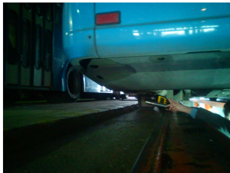
Слика 1. Мерење испарљивих органских материја издувних гасова непосредно на месту испуштања
