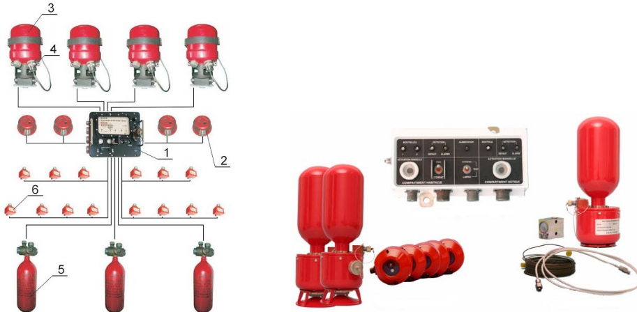
Слика 4. Компоненте система за заштиту борбених возила од експлозије горива и пожара, ВТИ- Београд и „Kidde-Deugra”
