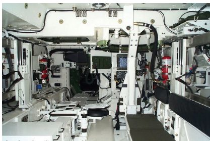
Слика 2. Унутрашњост борбеног возила пешадије типа „Stryker”- САД и главног борбеног тенка „Al Khalid”- Пакистан, компоненте противпожарног система су обојене у црвену боју
