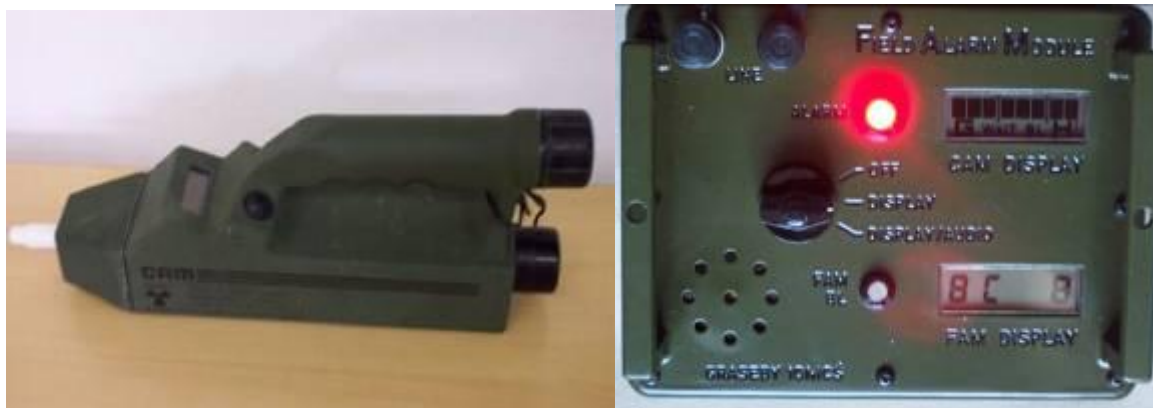
3. ábra: CAM vegyifelderítő készülék és riasztó egysége
